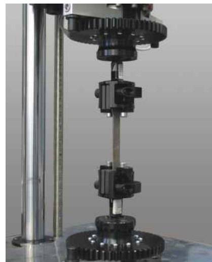
Рис.3: Испытание плоского образца
