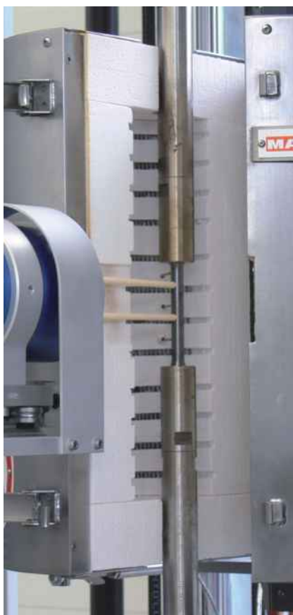
Рис.2: Испытание на растяжение в высокотемпературной печи
