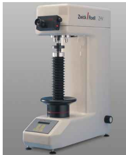
Рис.2: Ручной твердомер Виккерса для малых нагрузок Zwick/ZHV30
