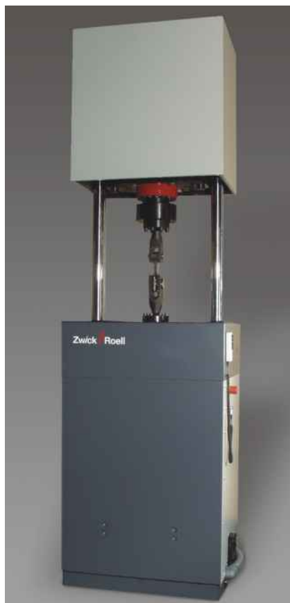
Рис.2: Высокочастотный пульсатор Amsler HFP 250
