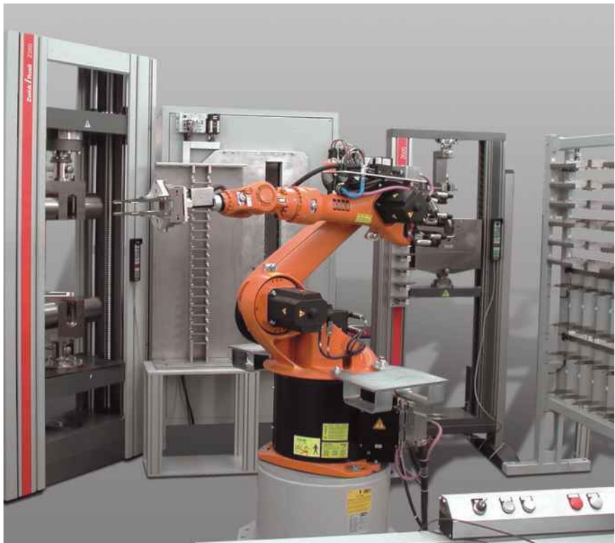
Рис.4: Роботизированная система для испытаний арматурной стали
