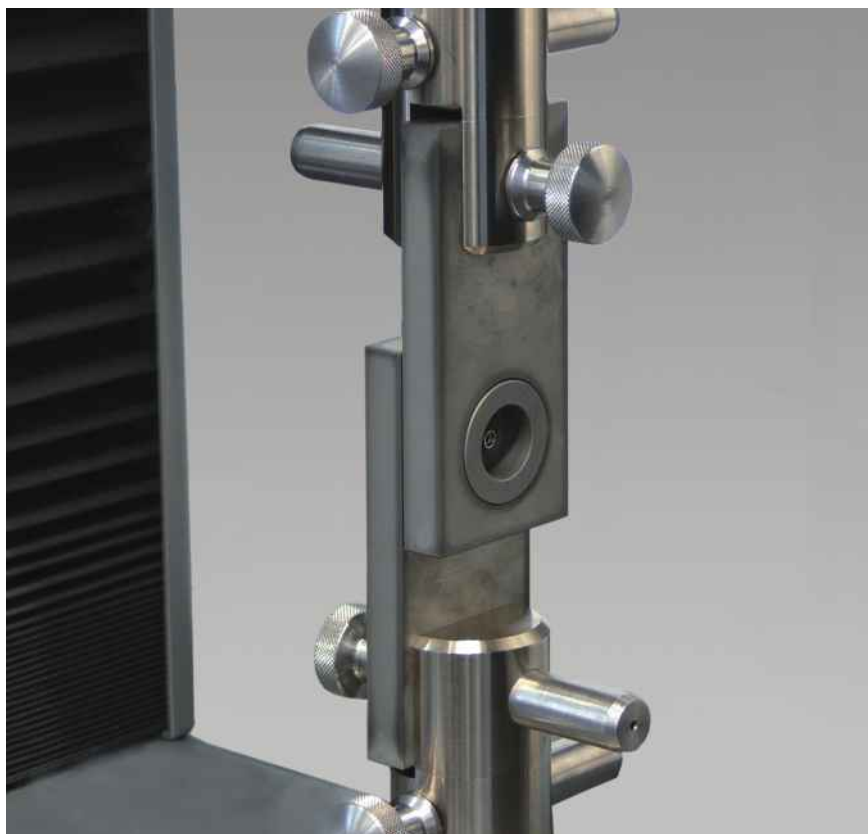
Рис.1: Испытание заклепочного соединения на срез
