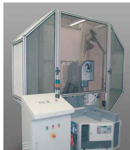
Рис.4: Маятниковый копер PSW 750 с полуавтоматической системой подачи образцов и термокамерой
