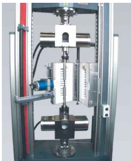
Рис.1: Машина для испытаний с высокотемпературной печью
