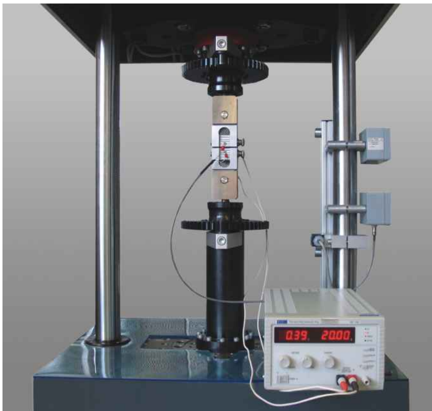
Рис.1: СТ-образец в высокочастотном пульсаторе (HFP)
