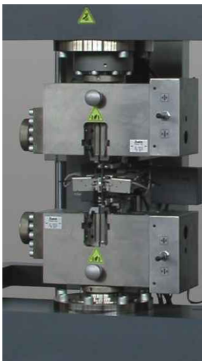
Рис.3: Датчик multiXtens комбинирует измерение малого растяжения и длинноходовое измерение
