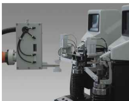
Рис.1: Автоматизированное испытание на твердость с двумя твердомерами
