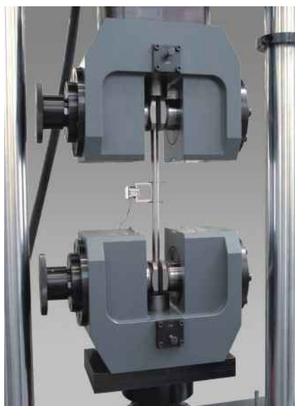
Рис.1: Испытание цилиндрического образца на усталость
