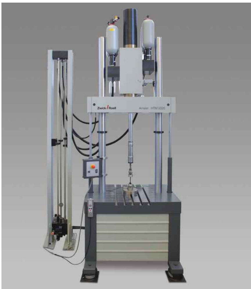
Рис.2: Высокоскоростная испытательная машина Amsler HTM 5020
