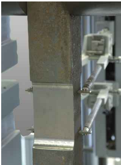
Рис.1: Образец из толстолистовой стали и датчиком продольной деформации Makro
