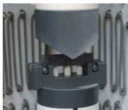
Рис.3: Испытание на изгиб в высокотемпературной печи
