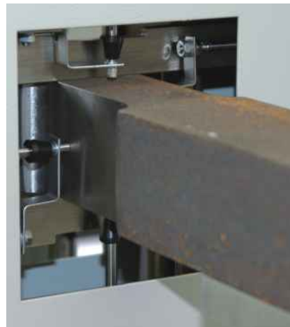
Рис.2: Образец из толстолистовой стали в автоматическом приборе для измерения поперечного сечения (QMG)
