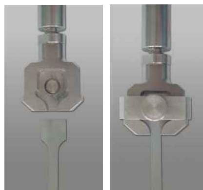
Рис.4: Захваты с геометрическим замыканием для плоских образцов
