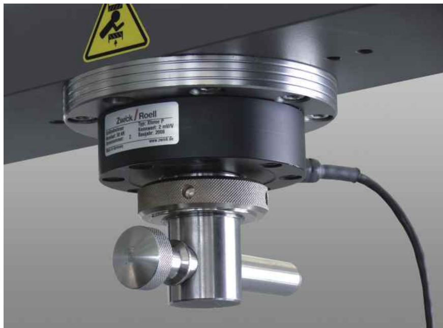
Рис.1: Датчик силы Xforce модели "комбинация изгибных балок"
