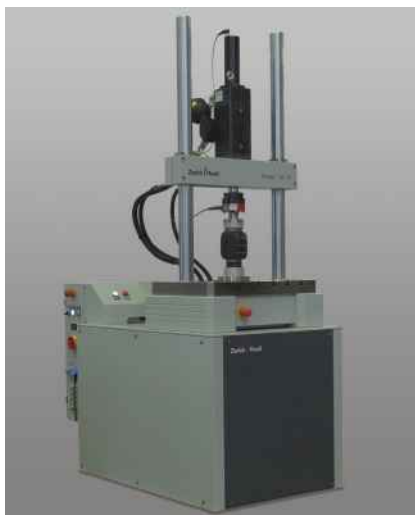
Рис.1: Сервогидравлическая испытательная машина Amsler HC-компакт
