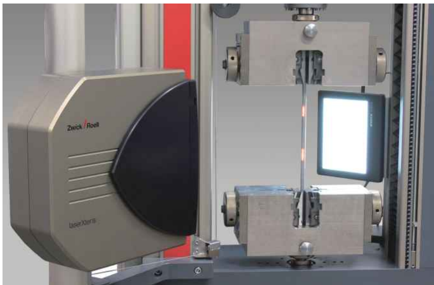
Рис.1: Датчик продольной деформации laserXtens с опцией videoXtens для измерения поперечной деформации
