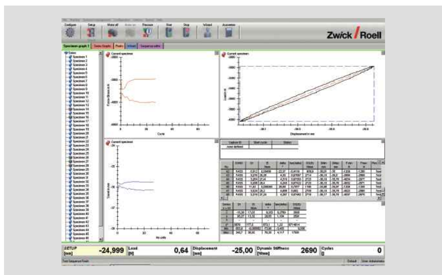
Рис.2: TestXpert®, испытание на усталость (скриншот)
