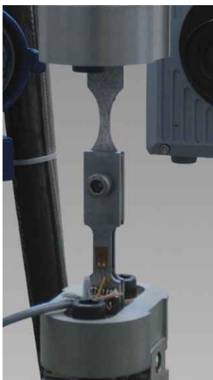
Рис.2: Металлический образец в машине для испытаний на быстрый разрыв
