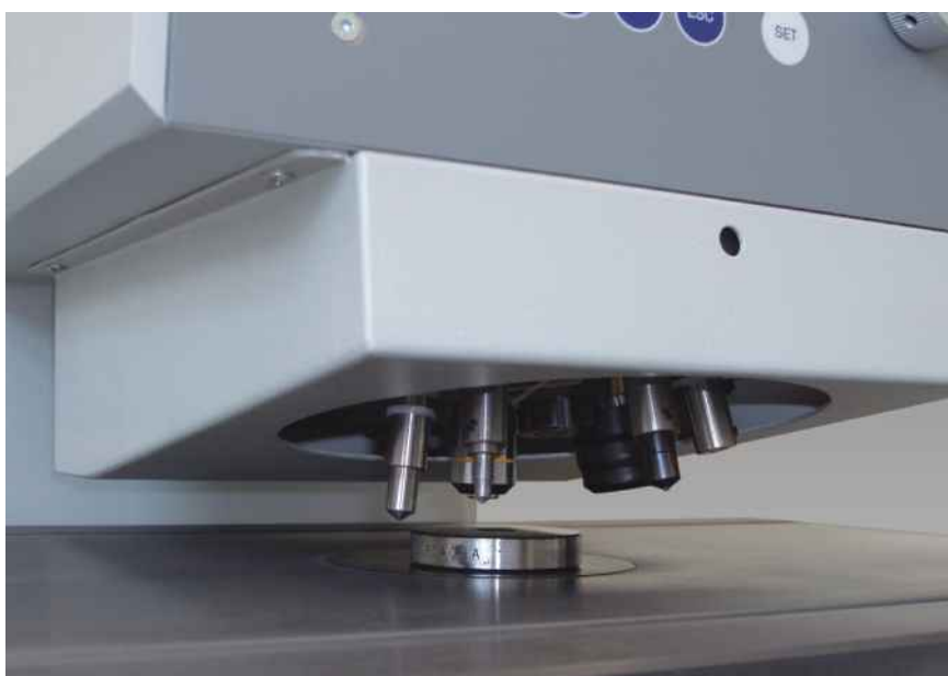
Рис.2: Револьверная головка для установки четырех инденторов и двух объективов
