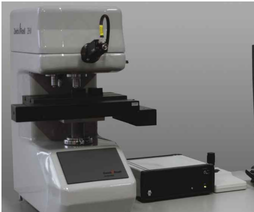
Рис.1: Микротвердомер Виккерса Zwick/ZHV1 с моторизованным координатным столом и ПО testXpert®
