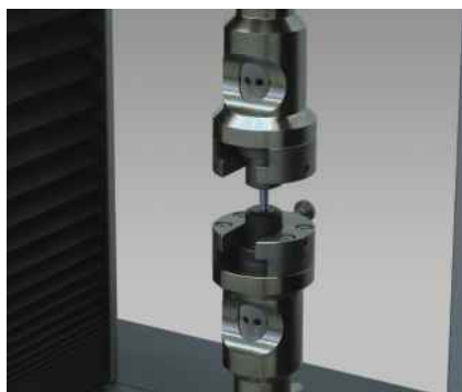
Рис.1: Захваты для болтов, образцов с запечками и резьбовыми головками
