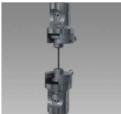
Рис.1: Испытание цилиндрического образца на растяжение
