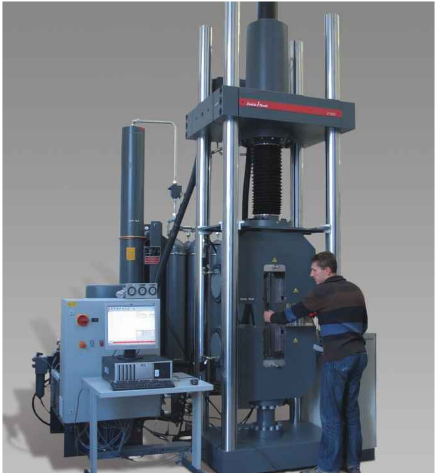
Рис.1: Рассчитанная на большие нагрузки машина для испытаний на сейсмостойкость по стандарту
