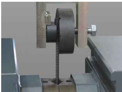
Рис.2: Испытание решетчатой опоры на срез
