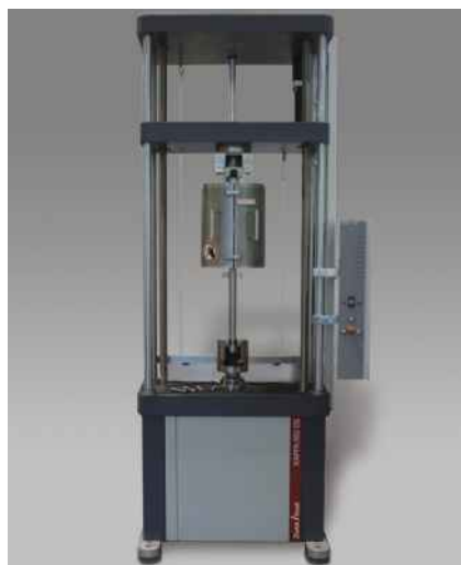
Рис.1: Машина для испытаний на длительную прочность с двухшпиндельным приводом
