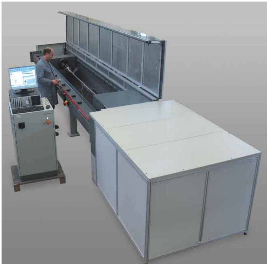
Рис.1: Горизонтальная машина для испытаний стальных тросов
