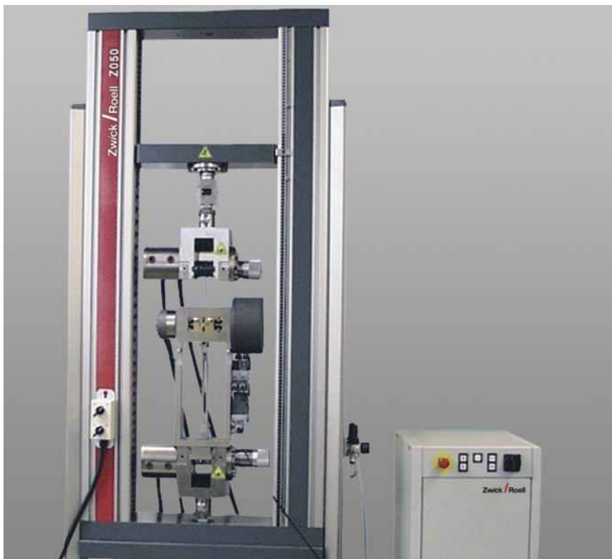
Рис.1: Испытательная машина Z050 с приспособлением "Draw-Bead"
