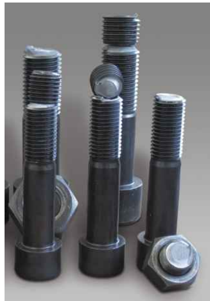
Рис.2: Болты после разрушения
