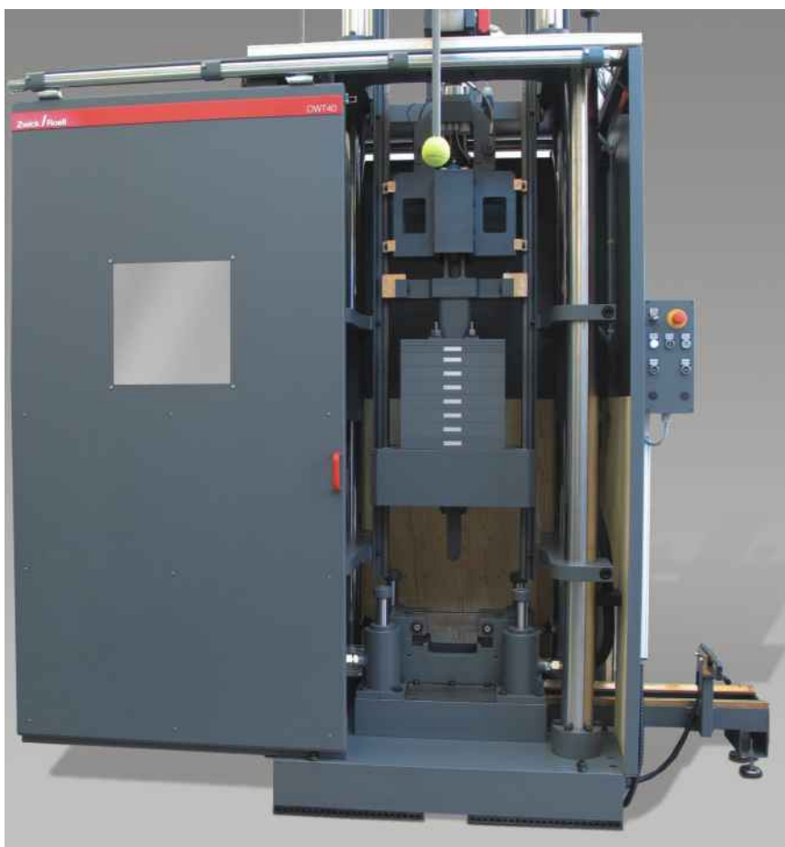
Рис.2: Большой копер с падающим грузом (DWT)
