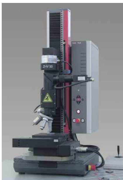
Рис.1: Машина Zwick/ZHV30/Z 2.5 для определения твердости по Виккерсу с моторизованным координатным столом
