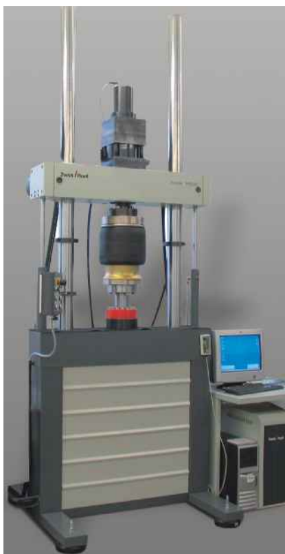
Рис.2: Сервогидравлическая машина Amsler HB 250
