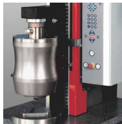
Рис.2: Универсальная испытательная машина Zwick/ZHU2.5/Z2.5 с головкой измерения твердости
