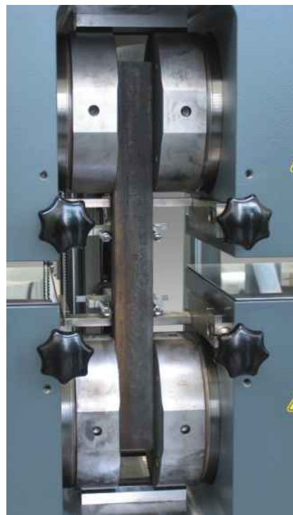
Рис.2: Испытание сегмента трубы на растяжение
