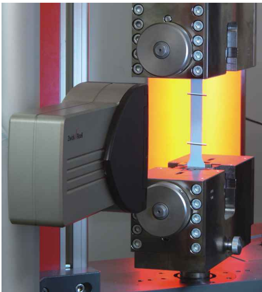
Рис.1: Испытание тонколистового проката на растяжение с датчиком videoXtens (в данном случае с опцией измерения поперечной деформации)
