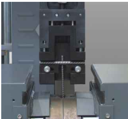
Рис.1: Испытание сварного шва, T-образное соединение
