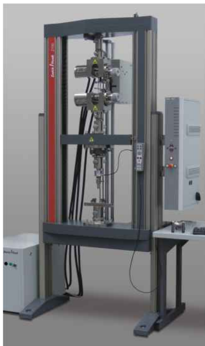
Рис. 1: Машина в настольном исполнении серии Allround-Line Z100
