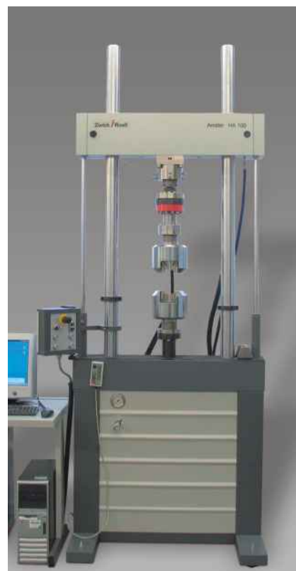
Рис.3: Сервогидравлическая машина Amsler HA 1005
