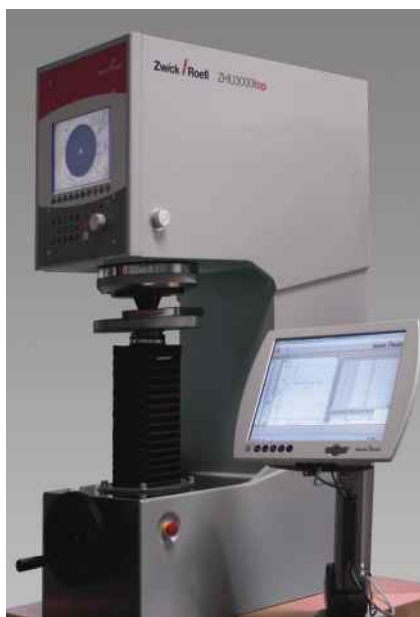
Рис.1: Универсальная машина Zwick/ZHU 250 top с привязкой к ПО testXpert® II
