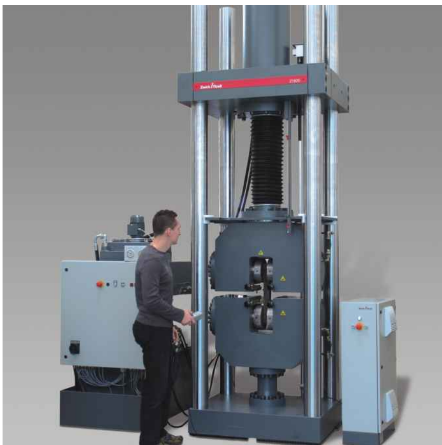
Рис.3: Машина для испытаний с большими нагрузками с гидравлическими захватами с двусторонним закрытием
