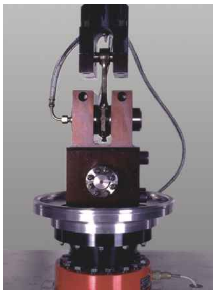
Рис.2: Испытание шатуна на усталость в масляной среде
