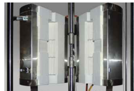
Рис.3: Открытая печь с термоэлементами
