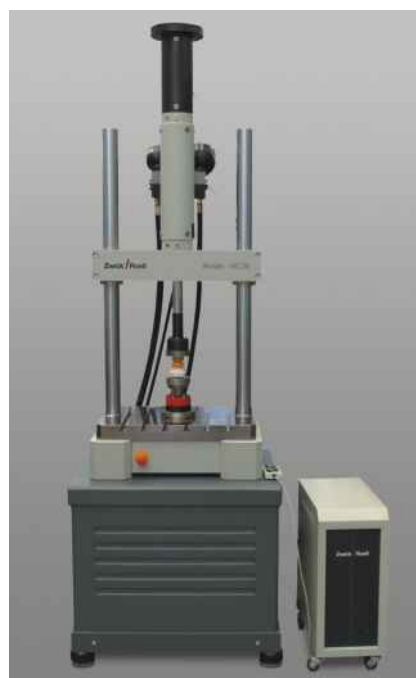
Рис.2: Сервогидравлическая машина Amsler HBT для испытаний на растяжение, сжатие и кручение
