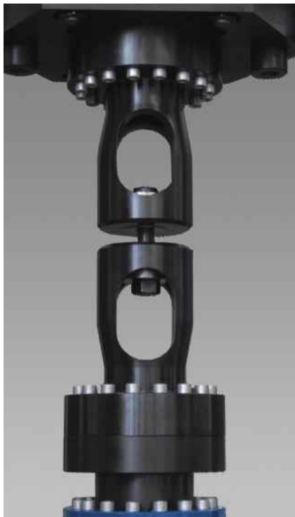
Рис.1: Испытание болтов на усталость
