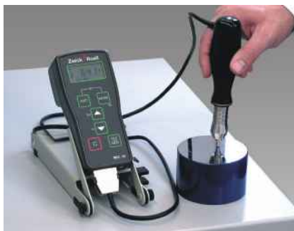
Рис.2: Переносной твердомер Zwick MIC 10
