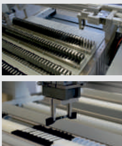
Рис. 1: 'roboTest L', испытания пластмасс и резины на растяжение и изгиб. Большой магазин для образцов позволяет работать по ночам и в выходные.
