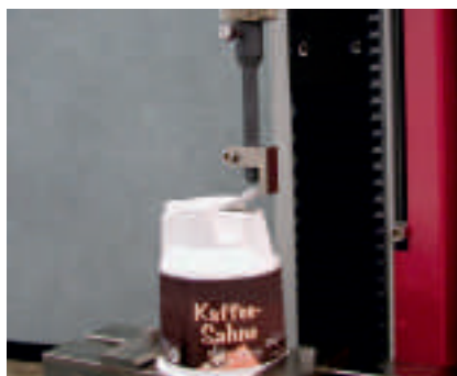
Рис. 5: определение усилия вскрытия
