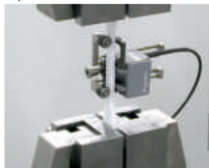
Рис. 1: цифровой датчик clip-on DigiClip
