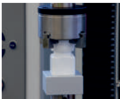
Рис. 7: функциональное испытание навинчивающихся крышек
