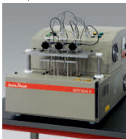
Рис. 2: прибор Allround HDT/Вика 3- или 6-300 А оснащен платформой. Это позволяет проводить испытания полностью автоматически. Размер ванны подходит для трех или шести измерительных станций.
