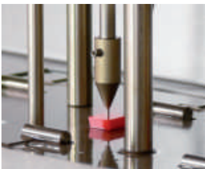
Рис. 4: испытание по VST согласно ISO 306: измерение проникновения иглы под нагрузкой
