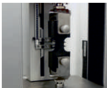
Рис. 4: испытание на растяжение по ISO 6259-1: используются различные формы образцов, в зависимости от толщины стенки
