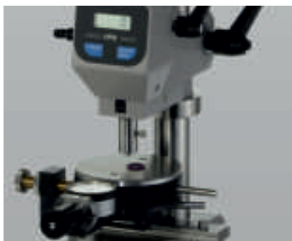
Рис. 6: измерение твердости кольца по IRHD
