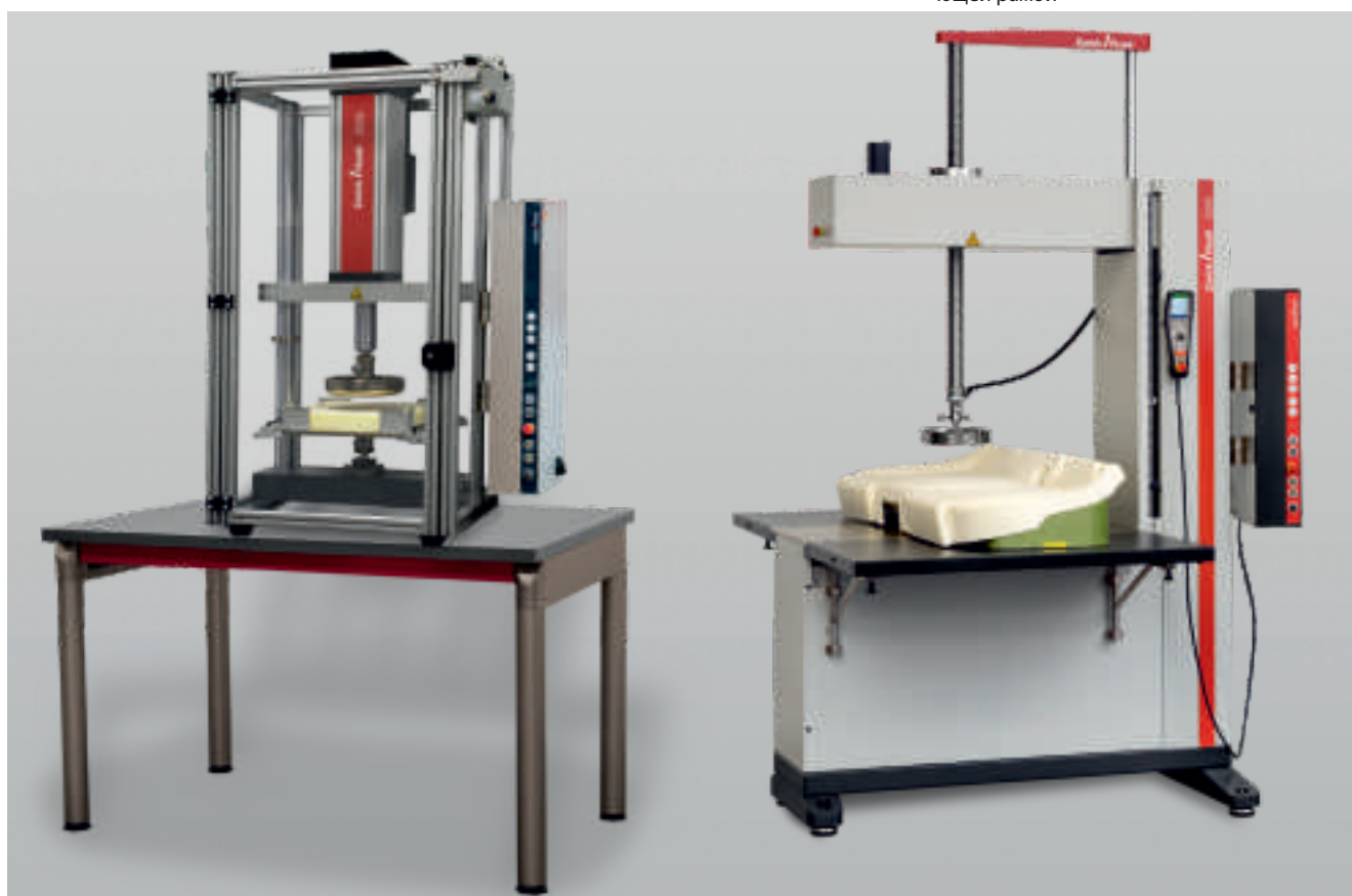
Рис. 1: специальные машины для испытаний мягких пенных материалов: слева комбинированная машина для определения твердости при вдавливании и усталостных испытаний. Справа С-образная нагружающая рама для испытаний больших и малых фасонных изделий.
