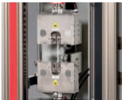
Рис. 1: испытание на растяжение по ISO 527-2 с определением модуля растяжения (характеристики формовочной массы)
