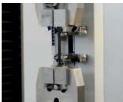
Рис. 4: испытание на растяжение по ISO 6259-1: используются различные формы образцов, в зависимости от толщины стенки
