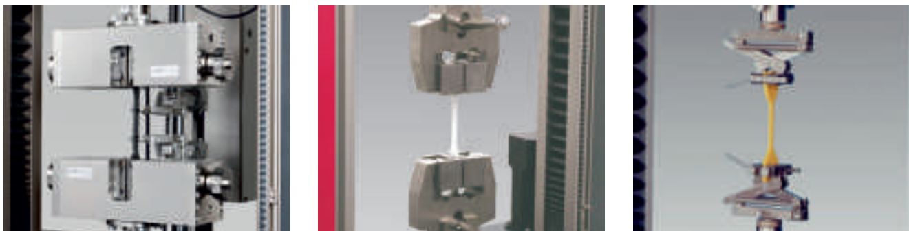
Рис. 2: клино-винтовые и клиновые захваты с зависимым от нагрузки зажимом надежно удерживают хрупкие и мягкие материалы
