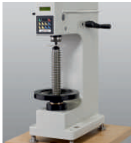
Рис. 5: твердомер 3106, вдавливание шарика
