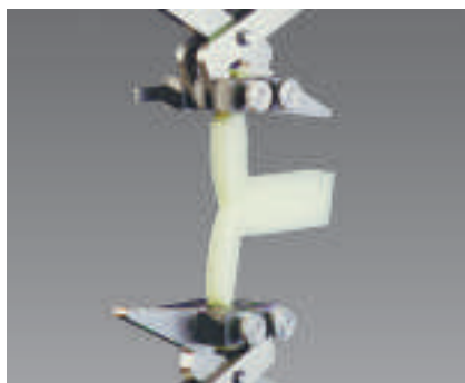
Рис. 2: испытание на раздир (ISO 8067)
