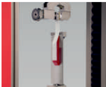
Рис. 6: отрыв под углом 180° по EN 1939 и AFERA 4001
