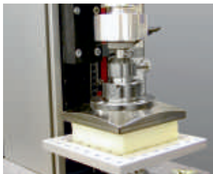
Рис. 1: свойства при сжатии, твердость при смятии (ISO 3386)
