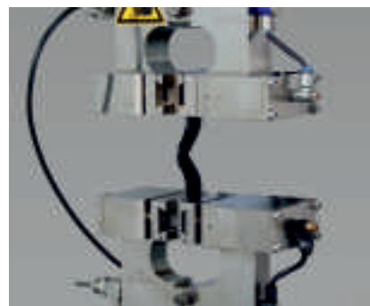
Рис. 3: разрыв углового образца по ISO 34-1
