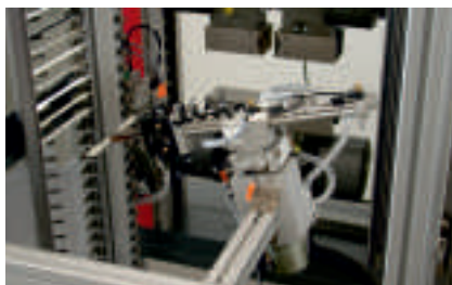
Рис. 1: автоматическая подача до 20 образцов стабильной формы, 'roboTest A'.
