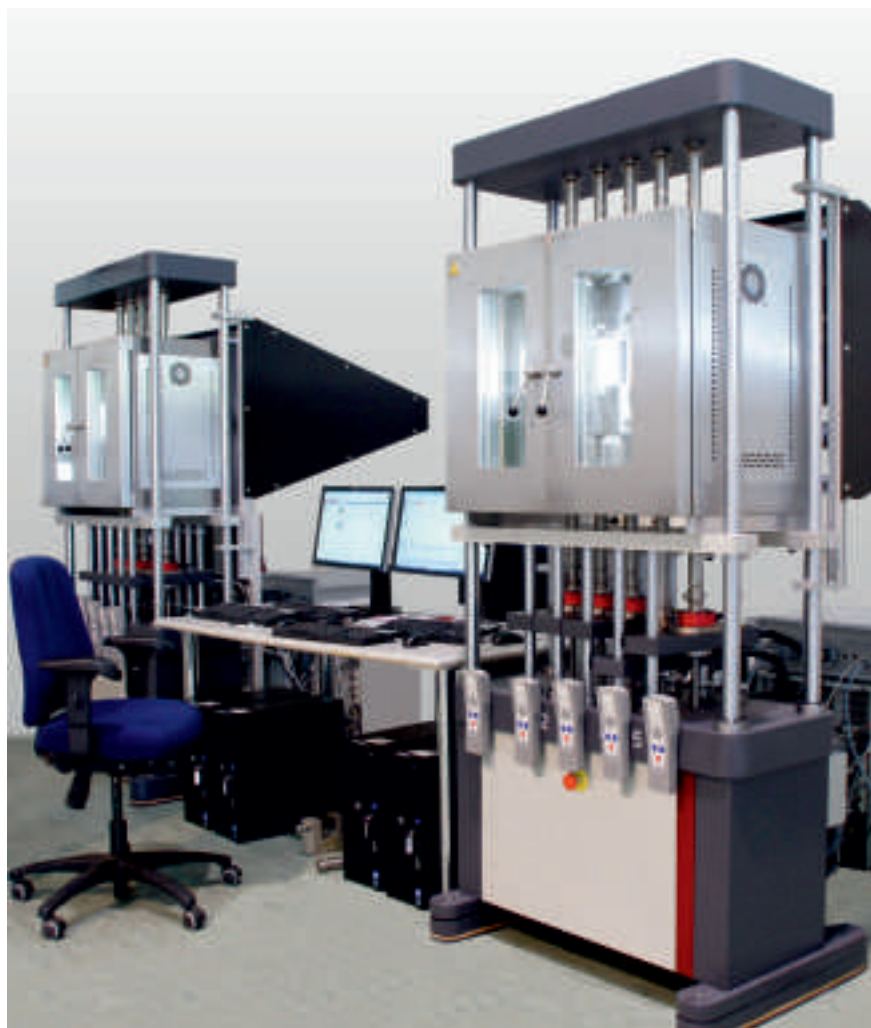
Рис. 2: испытательная система с 2 нагружающими рамами (5 станций и 1 термокамера на каждой)
