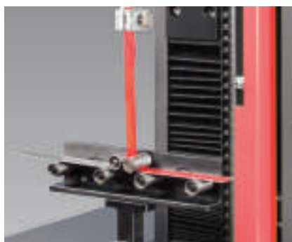
Рис. 1: отрыв под углом 90° для измерения сопротивления отслаиванию
