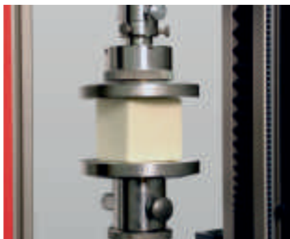
Рис. 3: испытание на сжатие по ISO 844 без прямого измерения перемещения (слева) и с ним (справа)
