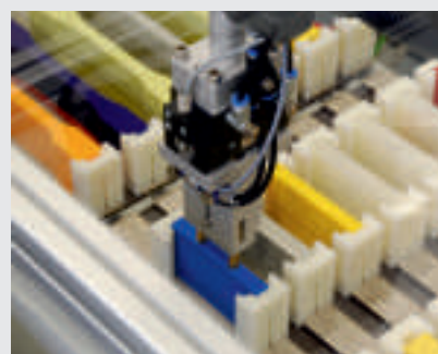
Рис. 2: 'roboTest R': возможна подача образцов для разных испытаний (например, на растяжение и изгиб, ударных испытаний или определения твердости). Большой магазин для образцов, можно также использовать для испытаний в термокамере.
