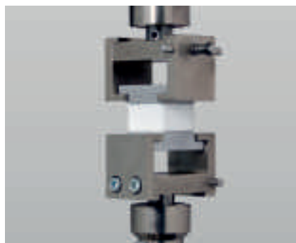
Рис. 4: растяжение с вертикальным приложением усилия по EN 1607
