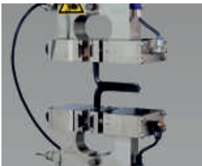
Рис. 2: разрыв образца "в форме брюк" по ISO 34-1
