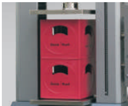
Рис. 1: определение штабелирования стаканчиков и ящиков для бутылок
