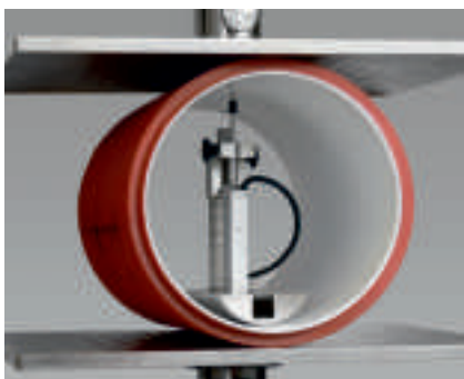
Рис. 2: для труб диаметром до 630 мм предлагаются специальные датчики перемещения
