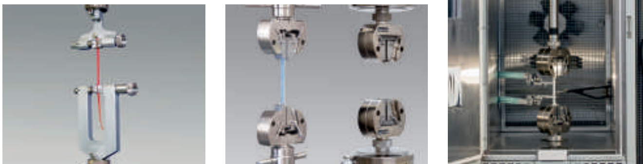
Рис. 4: специальные захваты для определенных материалов и форм образцов: цанговый захват, приспособление для испытания колец, шарнирные захваты
