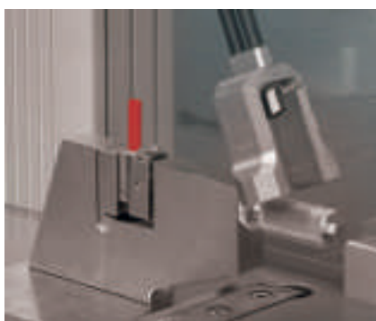
Рис. 2: механизм для испытаний по Изод
