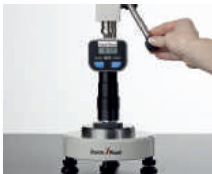
Рис. 2: измерение твердости по Шор А, ISO 7619-1
