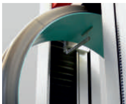
Рис. 1: измерение кольцевой прочности по ISO 9969: Кольцевая деформация измеряется на внутреннем диаметре.
