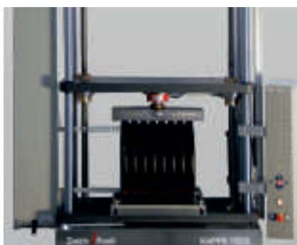
Рис. 3: испытания сегментов труб на длительную прочность
