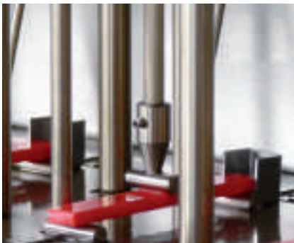
Рис. 3: испытание по HDT согласно ISO 75-2: постоянный нагрев образца в масляной ванне
