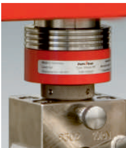
Рис. 1: датчики силы отвечают наивысшим требованиям к качеству. Слева: датчик силы модельного ряда Xforce, работающий по принципу деформируемых элементов. В центре: модель Xforce HP, работает по принципу измерения кольцевого кручения.
