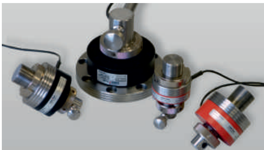
Рис. 1: датчики силы отвечают наивысшим требованиям к качеству. Слева: датчик силы модельного ряда Xforce, работающий по принципу деформируемых элементов. В центре: модель Xforce HP, работает по принципу измерения кольцевого кручения.
