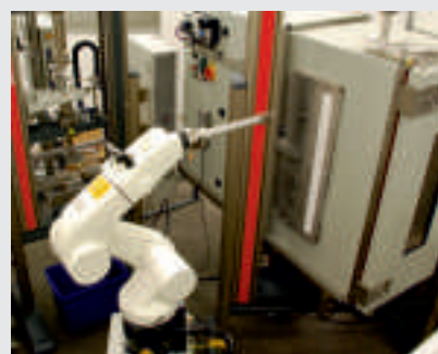
Рис. 3: подача образцов по Шарпи и Изод, 'roboTest H'
