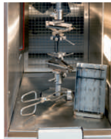
Рис. 3: вставки для вывода и ввода термокамеры без снятия захватов
