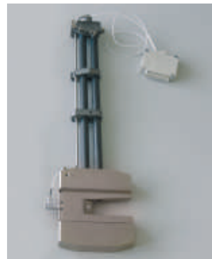
Рис. 5: для испытаний по Шарпи молот маятника инструментирован.
