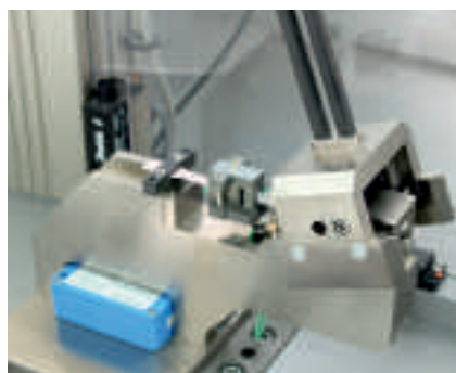
Рис. 2: инструментированное ударное испытание: датчик силы расположена на зажиме
