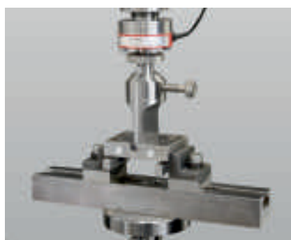
Рис. 4: простое переоснащение с растяжения на изгиб с помощью механических шибров и шаблонов
