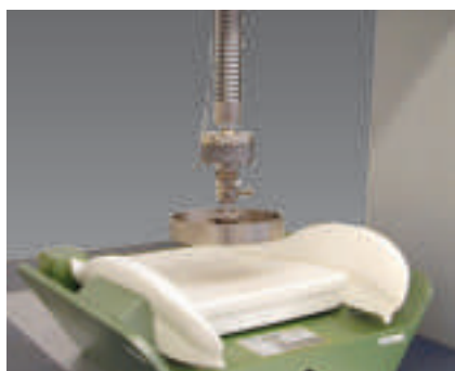
Рис. 3: твердость фасонных изделий при вдавливании (DIN 53579-1)
