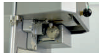
Рис. 3: отрезной механизм с затвором форсунки
