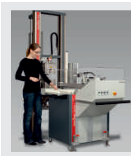
Рис. 1: 'roboTest L', испытания пластмасс и резины на растяжение и изгиб. Большой магазин для образцов позволяет работать по ночам и в выходные.
