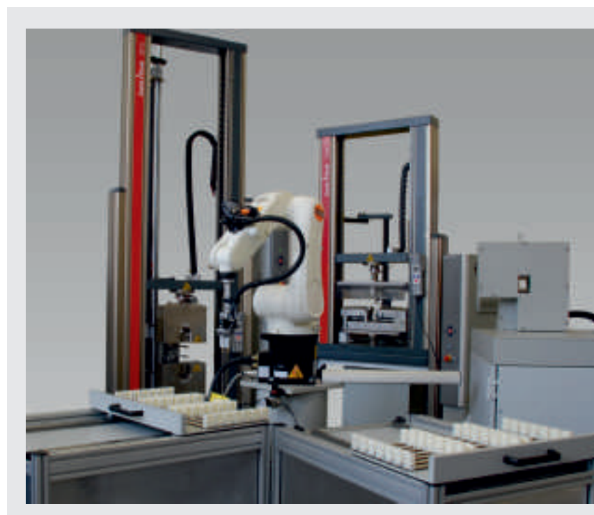
Рис. 2: 'roboTest R': возможна подача образцов для разных испытаний (например, на растяжение и изгиб, ударных испытаний или определения твердости). Большой магазин для образцов, можно также использовать для испытаний в термокамере.
