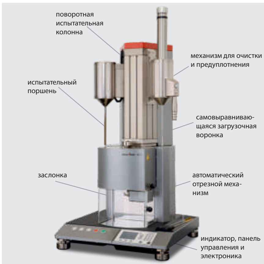
Рис. 2: А'ow - очень надежный пластометр с высокой степенью автоматизации для применения с наименьшим влиянием человеческого фактора.
