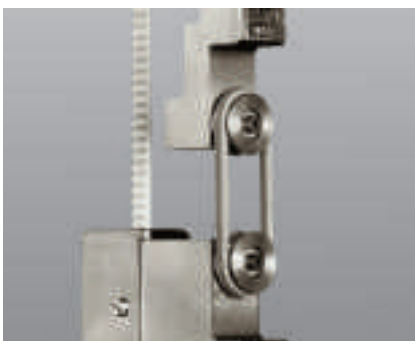
Рис. 4: испытание колец на растяжение по ISO 37
