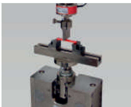
Рис. 4: простое переоснащение с растяжения на изгиб с помощью механических шибров и шаблонов
