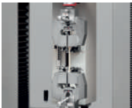
Рис. 2: испытание на растяжение, например, по ASTM D 638 (контроль качества)
