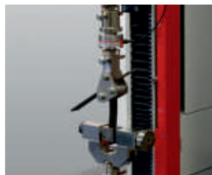
Рис. 5: испытание на отслаивание с роликов по ISO 4578
