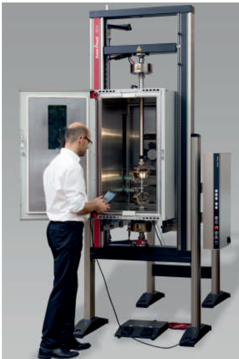
Рис. 1: машина AllroundLine с термокамерой в позиции испытания. Измерение продольной деформации осуществляется через боковой паз.
