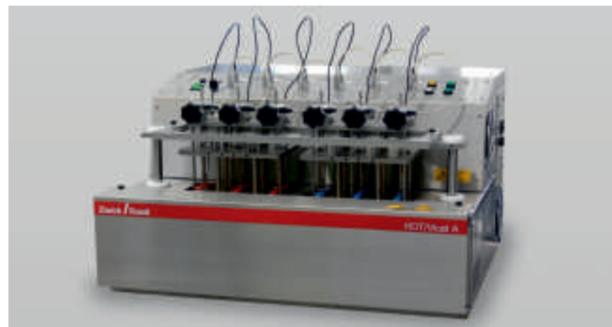
Рис. 2: прибор Allround HDT/Вика 3- или 6-300 А оснащен платформой. Это позволяет проводить испытания полностью автоматически. Размер ванны подходит для трех или шести измерительных станций.
