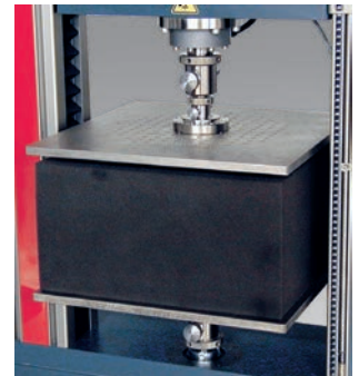
Bild 4: Schaumstoff-Prüfung mit Druckplatten 400 x 400 mm
