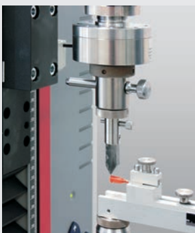
Bild 9: Test an Injektionsnadeln
