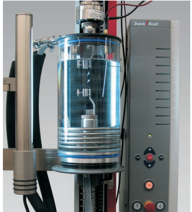
Bild 3: Prüfung im temperierten Wasserbad
