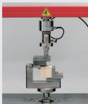
Bild 13: Scherprüfung an Holz
