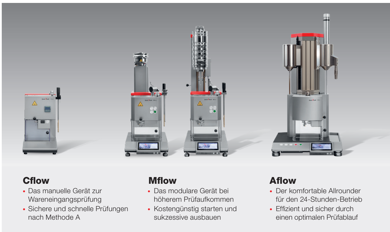
Bild 1: Cflow, Mflow, Mflow mit Gewichtsabsteckung und Aflow
