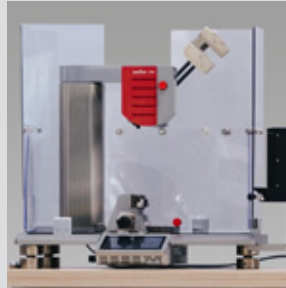
Bild 1: HIT5P mit fest montiertem Schutzgehäuse links und rechts
