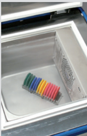
Bild 3: Temperierbox zum Kühlen von Proben/Probenmagazinen
