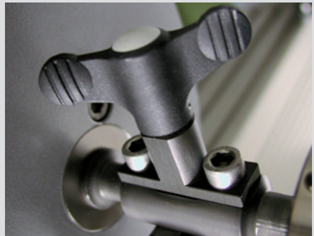
Bild 1: Der Pendelwechsel erfolgt über einen Schnellverschluss. Zusätzliche Werkzeuge werden nicht benötigt.
