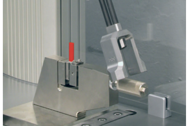
Bild 1: Prüfung mit manuellem Izod-Bock
