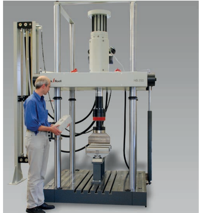
Bild 2: Viersäulige HB250 zur Werkstoff- und Bauteilprüfung
