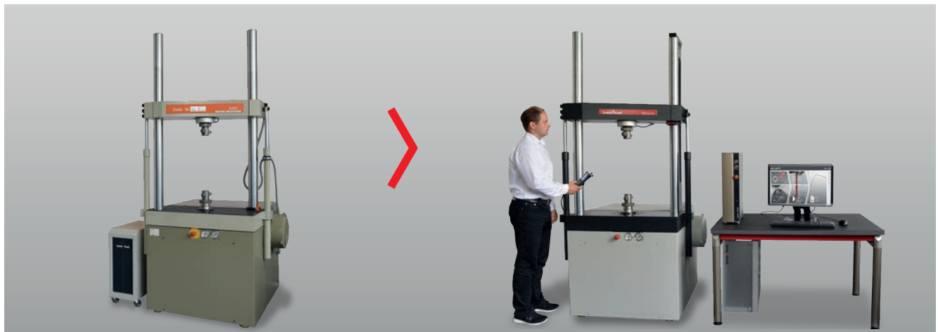
Bild 1: Modernisierung einer servohydraulischen Prüfmaschine mit testControl II sowie der Prüfsoftware testXpert Research
