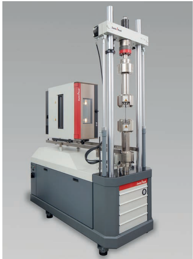
Bild 2: Servohydraulische Prüfmaschine HC-Kompakt 100 kN mit integriertem Hydraulikaggregat und Temperierkammer
