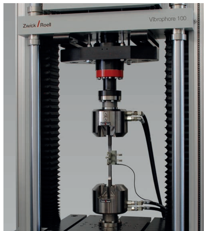
Bild 2: Integration von Längenänderungsaufnehmer makroXtens (oben) und Clip-On (unten) für statische Zugversuche
