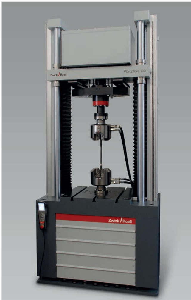
Bild 1: Hochfrequenzpulsator Vibrophore 100 mit hydraulischem Keil-Probenhalter
