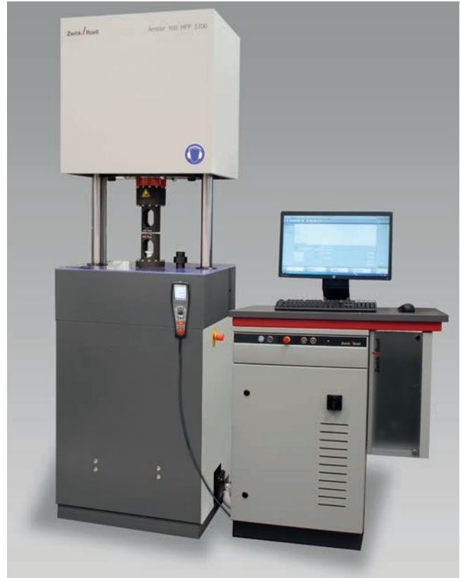
Bild 2: Modernisierung eines Hochfrequenzpulsators mit testControl II
