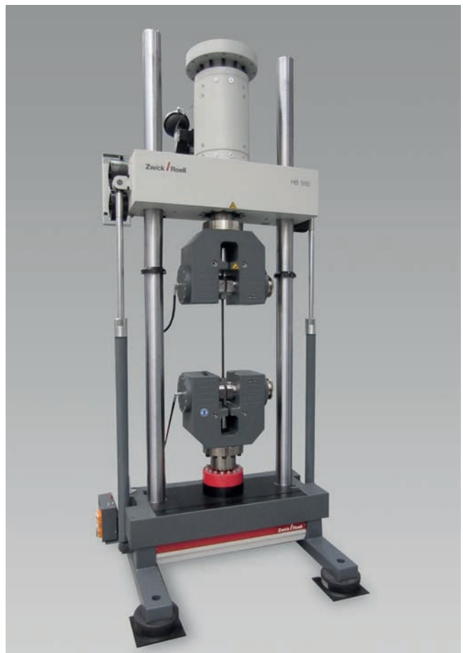
Bild 2: Dauerschwingversuch an Litzen gemäß ISO 15630-3
