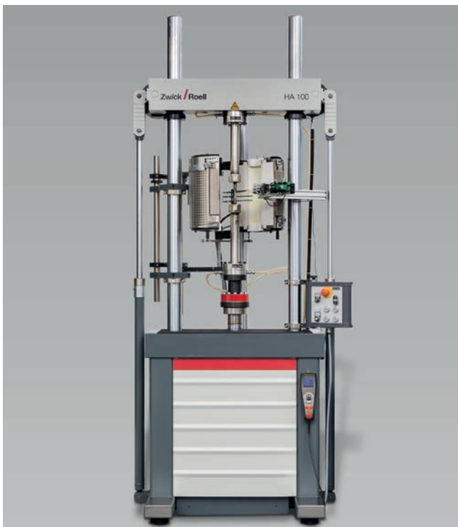
Bild 1: HA 100 für Low-Cycle-Fatigue Versuche (LCF) unter Hochtemperatur bis 1.200 °C
