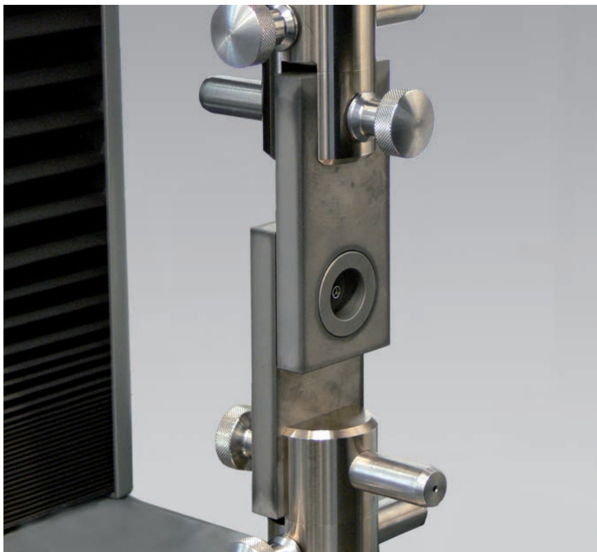
Bild 1: Scherversuch an Nietverbindung
