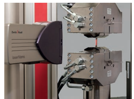
Bild 6: laserXtens Compact für kurze Proben
