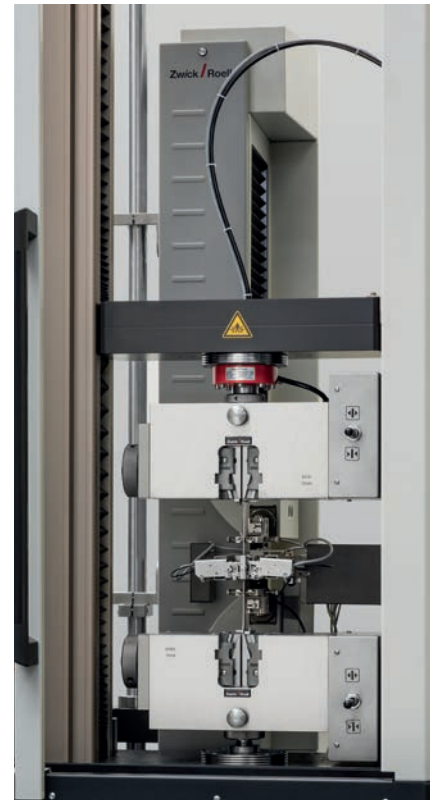
Bild 4: multiXtens mit optionaler Feindehnungs- und Breitenänderungsmessung
