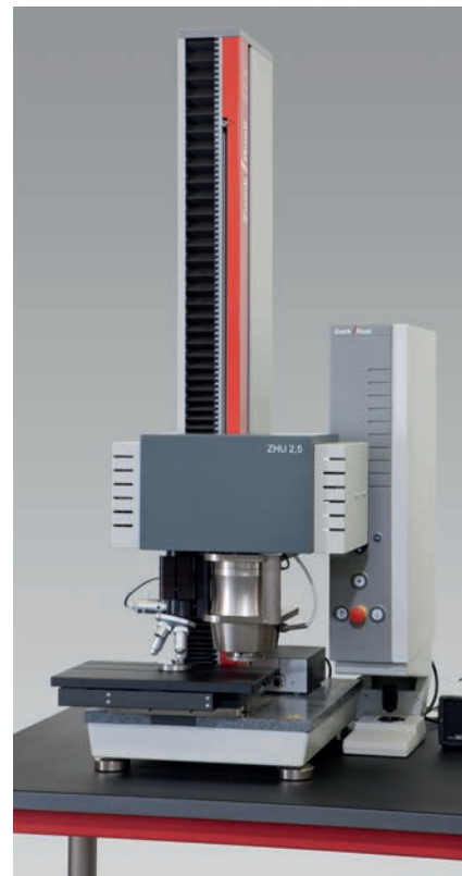
Bild 2: Universelle Härteprüfmaschine ZHU/zwickiLine
