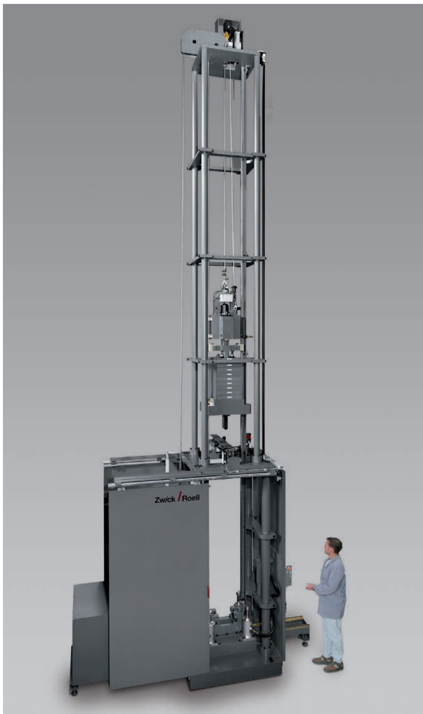
Bild 2: Groß-Fallwerk DWT 40 (Fallhöhe 5 m)
