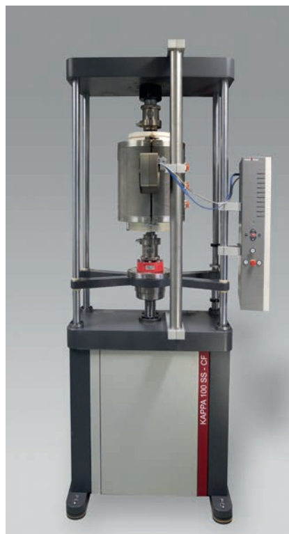
Bild 1: Elektromechanische Zeitstand-Prüfmaschine KAPPA DS (links), KAPPA SS - CF (rechts)
