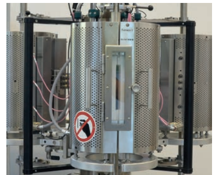
Bild 5: Karussell mit 3 Hochtemperatur-Öfen
