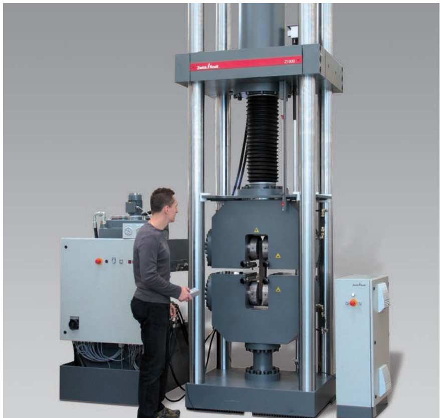
Bild 2: Großlast-Prüfmaschine mit beidseitig schließenden hydraulischen Probenhaltern
