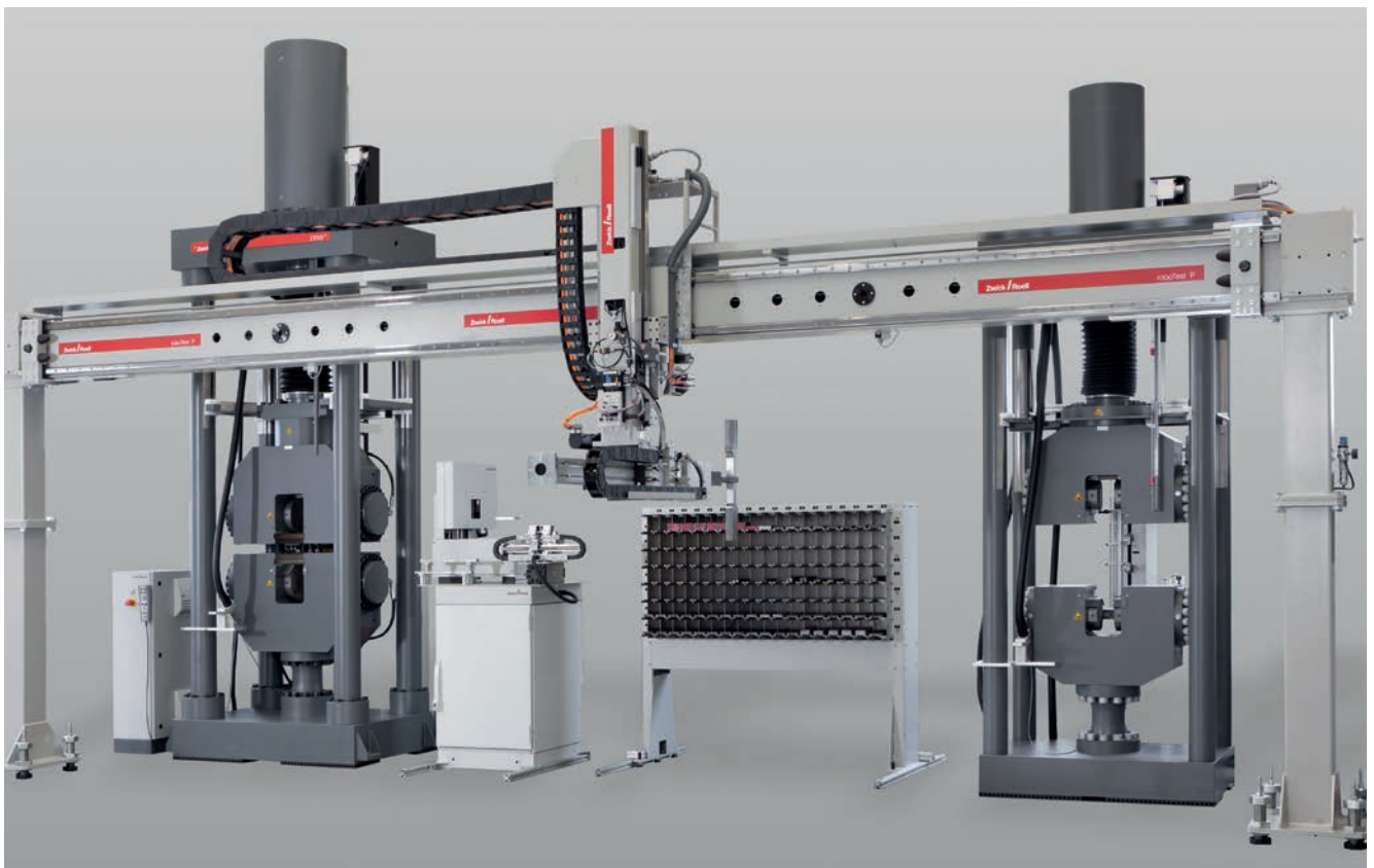
Bild 1: Automatisierte Zugprüfung an Grobblechproben mit Roboter-Prüfsystem roboTest P
