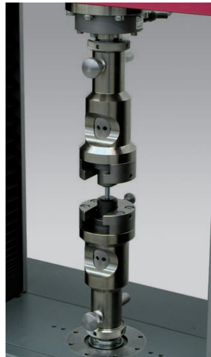
Bild 2: Zugversuch an Schrauben
