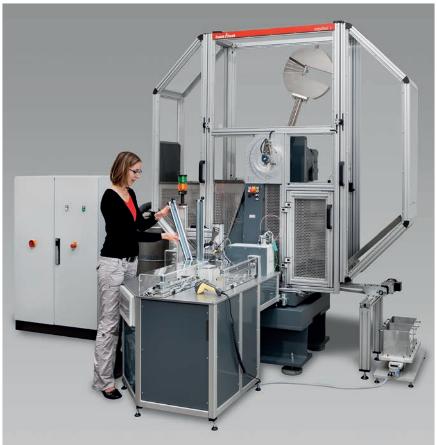
Bild 2: roboTest I für automatisierte Charpy- und Izod-Versuche (inklusive Probenkühlung)
