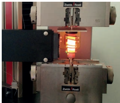
Bild 3: Induktionsheizung mit laserXtens
