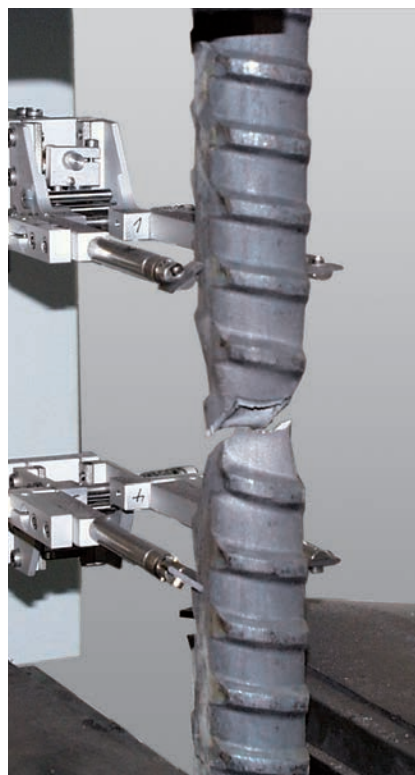
Bild 1: Zugversuch an Betonrippenstahl mit Längenänderungsaufnehmer makroXtens
