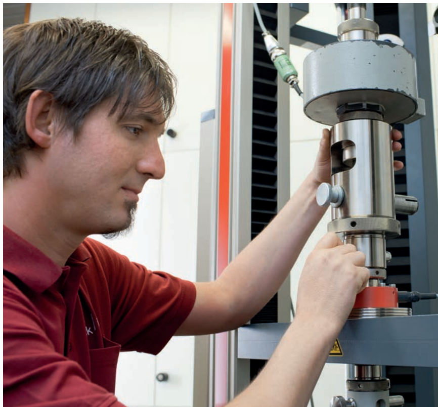
Bild 2: Jeder Kraftaufnehmer erhält eine ZwickRoell-Werkskalibrierung sobald er an einer Prüfmaschine zum Einsatz kommt.
