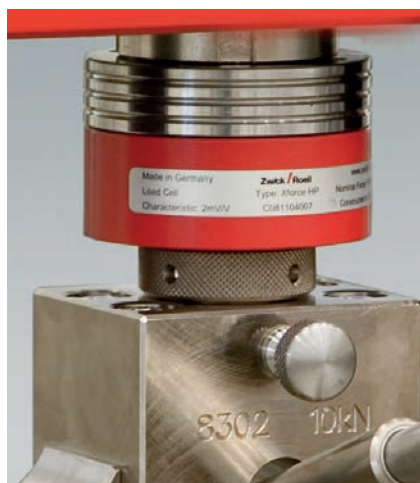
Bild 1: Kraftaufnehmer im Einsatz
