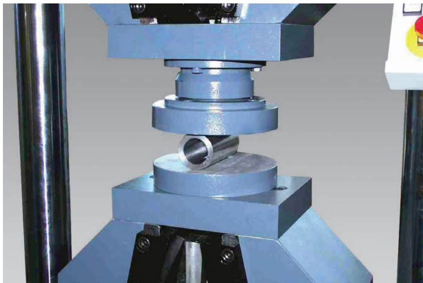
Bild 1: Scheitel-Druckversuch an Spezialrohr
