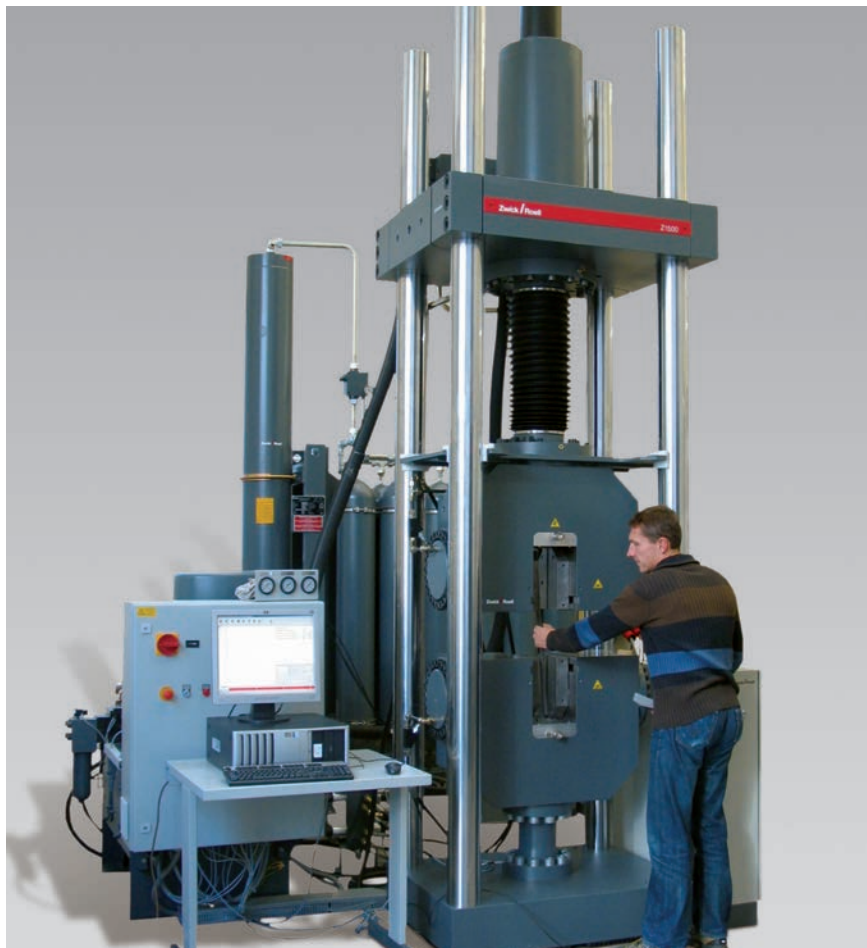
Bild 1: Großlast-Prüfmaschine für Erdbebenversuche nach Norm
