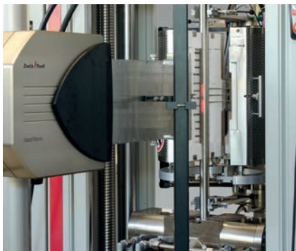
Bild 1: Hochtemperatur-Ofen mit laserXtens
