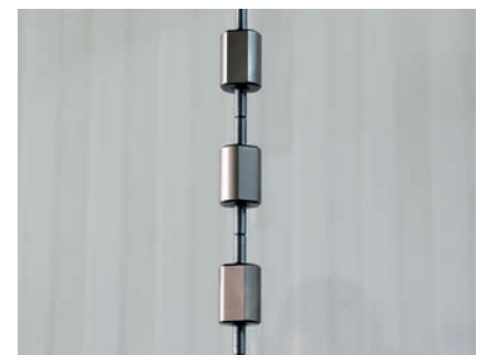
Bild 3: Überprüfung der Wasserstoffversprödung nach ASTM F 519
