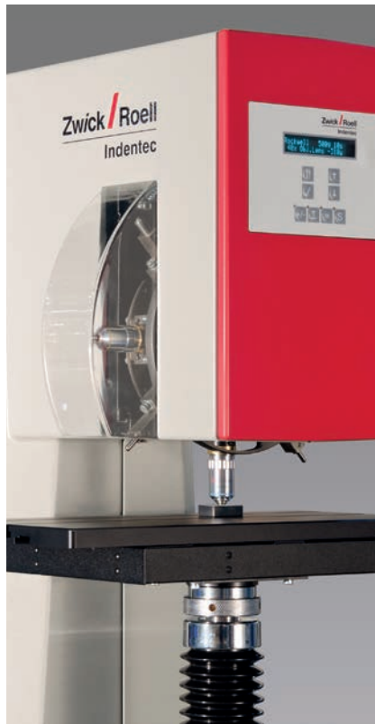
Bild 2: Universelle Härteprüfmaschine ZHU 250CL
