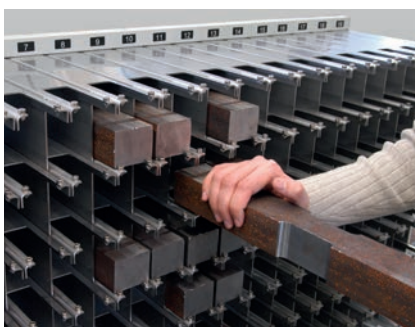
Bild 2: roboTest P für automatisierte Zugversuche schweren Proben mit integration zusätzlicher Sensorik und Messgeräte (z.B. Querschnittsmessgerät, unten rechts)
