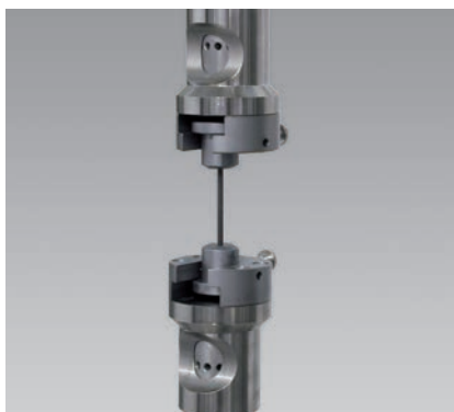
Bild 1: Zugversuch an Rundprobe
