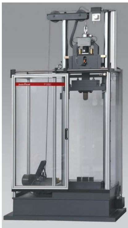
Bild 2: Pellini-Fallwerk und Prüfkörper, sowie Proben nach dem Versuch
