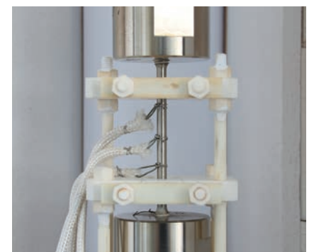
Bild 4: Probe für den Zeitstand-Zugversuch (Extensometer und Thermolemente).
