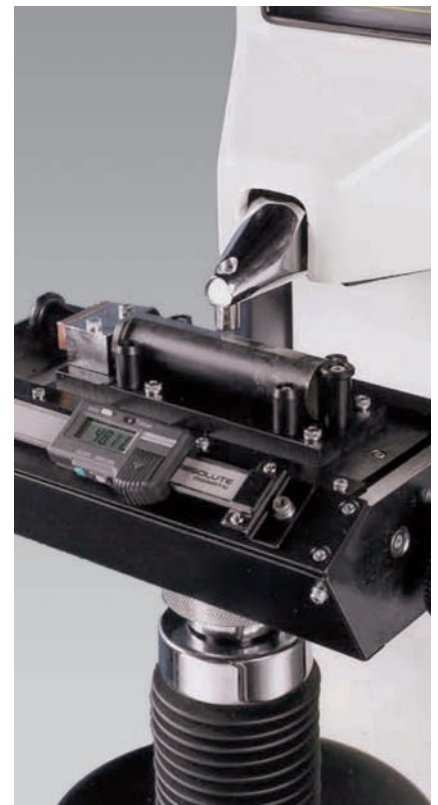
Bild 2: Jominy-Test an Einzelprobe
