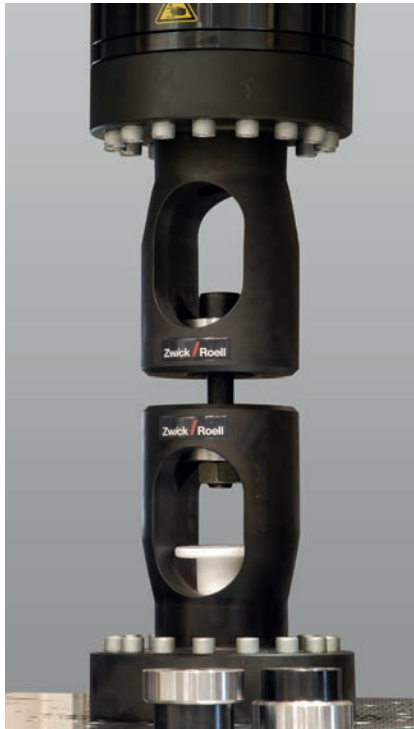
Bild 1: Ermüdungsprüfung an Schrauben
