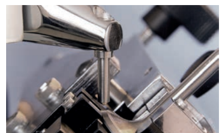
Bild 3: Rockwellprüfung an wärmefließgepressten Motorventilen
