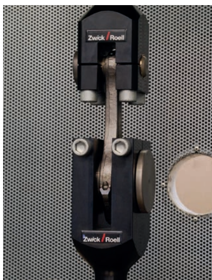
Bild 2: Ermüdungsprüfung an Pleuel
