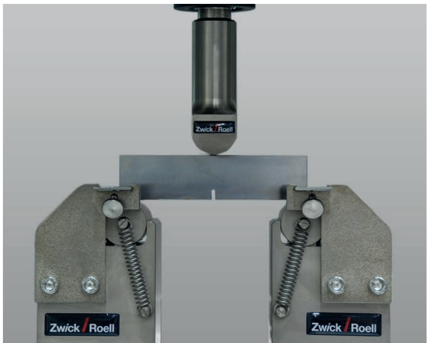
Bild 2: SENB Probe in Hochfrequenzpulsator Vibrophore
