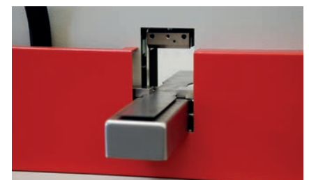
Bild 5: Querschnittsmessung an einer Flachprobe
