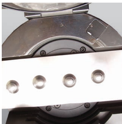
Bild 3: Versuchsergebnis nach Erichsen-Test
