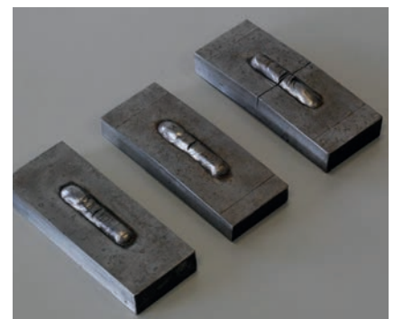
Bild 2: Pellini-Fallwerk und Prüfkörper, sowie Proben nach dem Versuch
