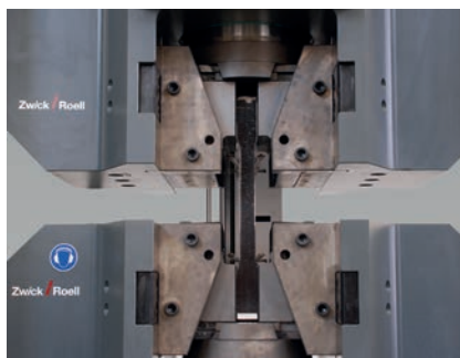
Bild 4: Hydraulische Großlast-Probenhalter für Prüfanwendungen bis 2.500 kN
