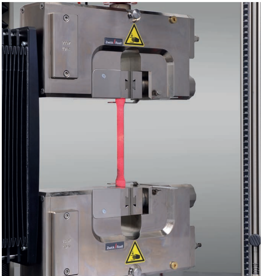
Bild 1: Zugversuch an Feinblechproben mit Längenänderungsaufnehmer laserXtens Array
