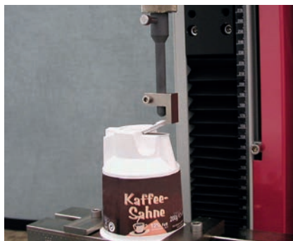
Bild 5: Bestimmung von Betätigungs Kräften
