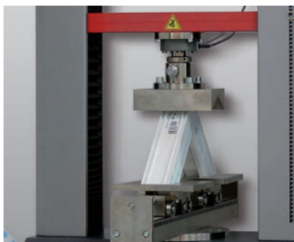
Bild 3: Eckfestigkeit eines Fensterprofils
