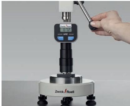
Bild 2: Shore A Härtemessung, ISO 7619-1
