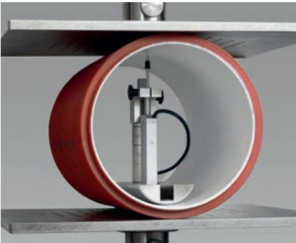
Bild 2: Für Rohre bis 630 mm Durchmesser stehen spezielle Wegaufnehmer zur Verfügung
