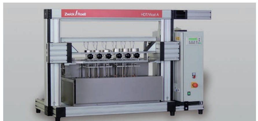
Bild 1: Das HDT/Vicat 3- bzw. 6-300 A verfügt über einen integrierten Wärmetauscher und ist mit einer Badgröße für drei oder sechs Messstationen ausgestattet.
