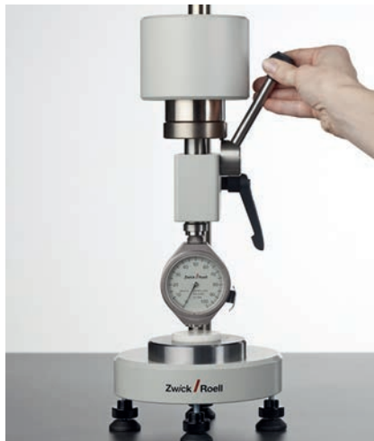
Bild 3: Analoges Shore A Härteprüfgerät mit Prüfstander
