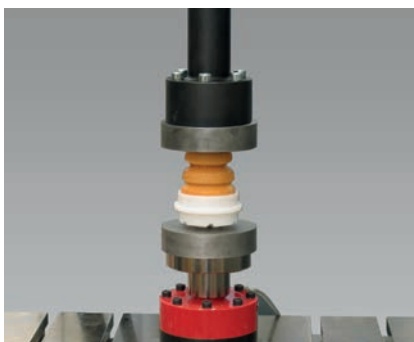
Bild 4: Dynamische Prüfung von Trittschallplatten und Endlagerndämpfern
