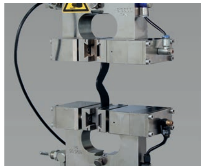
Bild 3: Weiterreiversuch an einer Winkelprobe nach ISO 34-1
