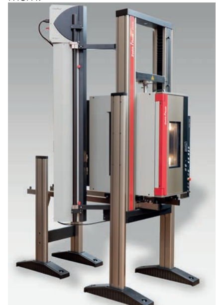
Bild 2: Die Temperiervorrichtung kann auf Schienen ausgefahren werden
