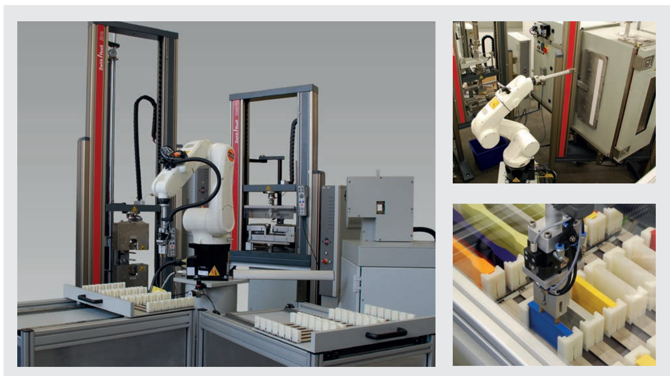
Bild 2: 'roboTest R': Die Probenzuführung integriert mehrere Prüfmittel, z.B. für Zug- und Biegeversuche Schlagprüfungen und Härte. Es verfügt über ein großes Probenmagazin und kann auch für Prüfungen in Temperierkammern eingesetzt werden.
