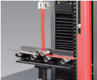
Bild 1: 90° Abzugsversuch zur Messung des Schälwiderstands
