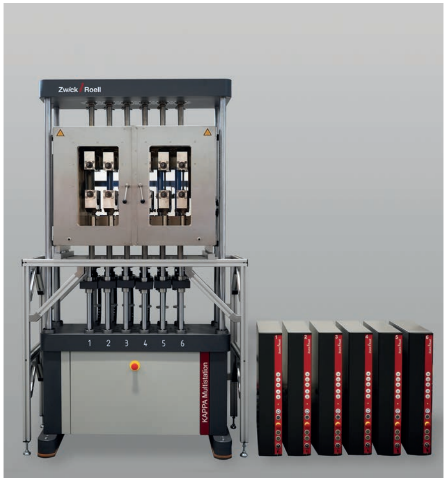
Bild 2: Zeitstandprüfanlage mit 2 Lastrahmen, je 5 Stationen und je 1 Temperierkammer
