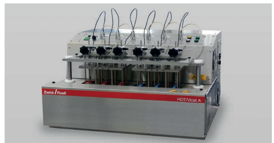
Bild 2: Das Allroundgerät HDT/Vicat 3- bzw. 6-300 A ist mit einer Hebebühne ausgestattet. So kann die gesamte Prüfung automatisch ablaufen. Es ist mit einer Badgröße für drei oder sechs Messstationen ausgestattet.
