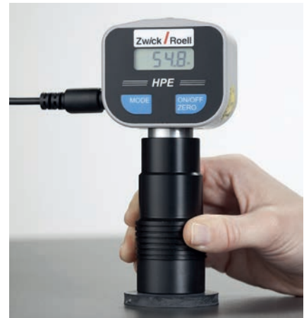
Bild 4: Digitales Shore-Härteprüfgerät mit integrierter Elektronik
