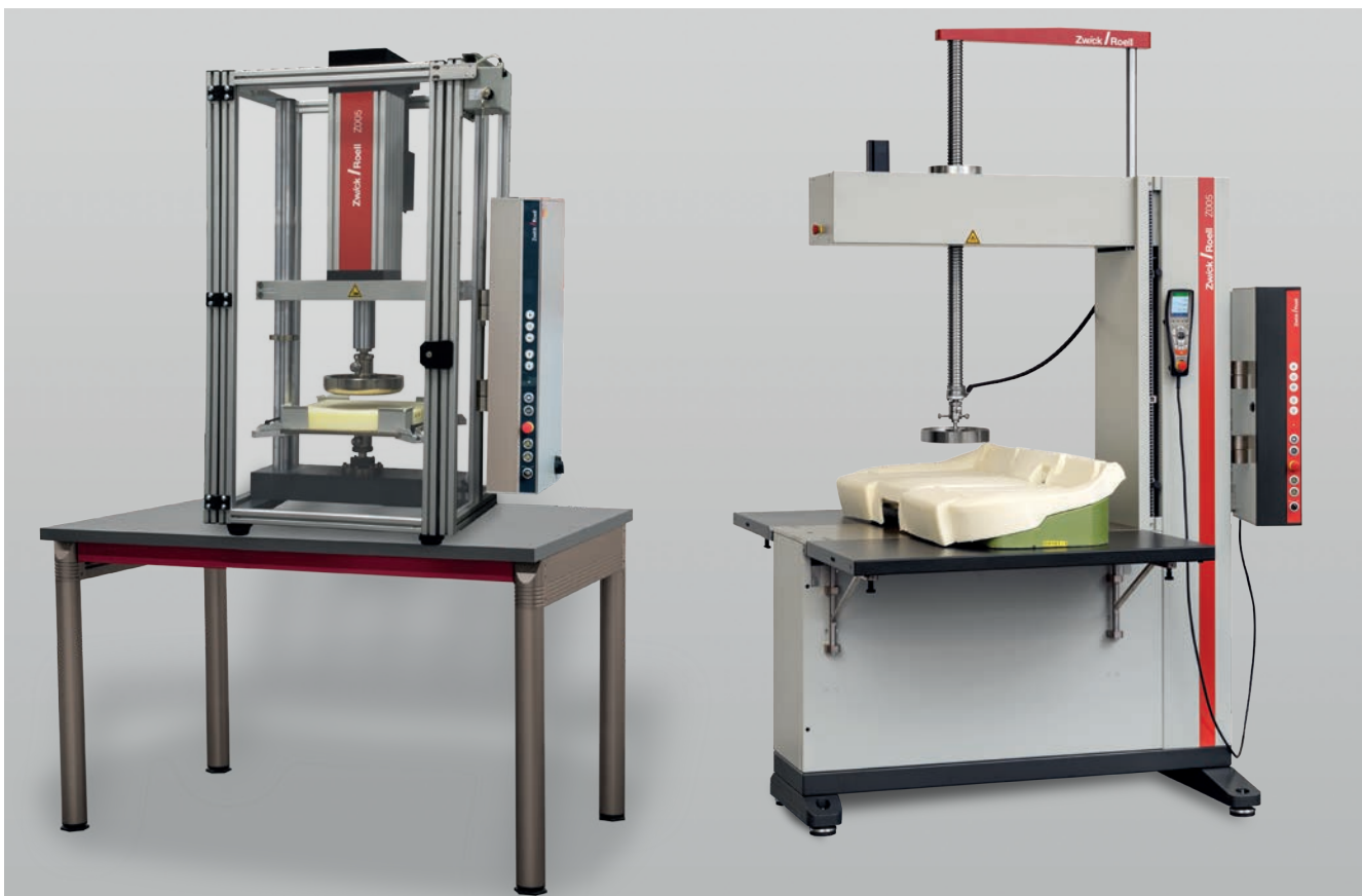
Bild 1: Spezielle Prüfmaschinen für Weichschäume: Links, kombinierte Prüfmaschine für Eindrückhärte und Dauerschwingversuch. Rechts, C-förmiger Lastrahmen für große und kleine Formteile.
