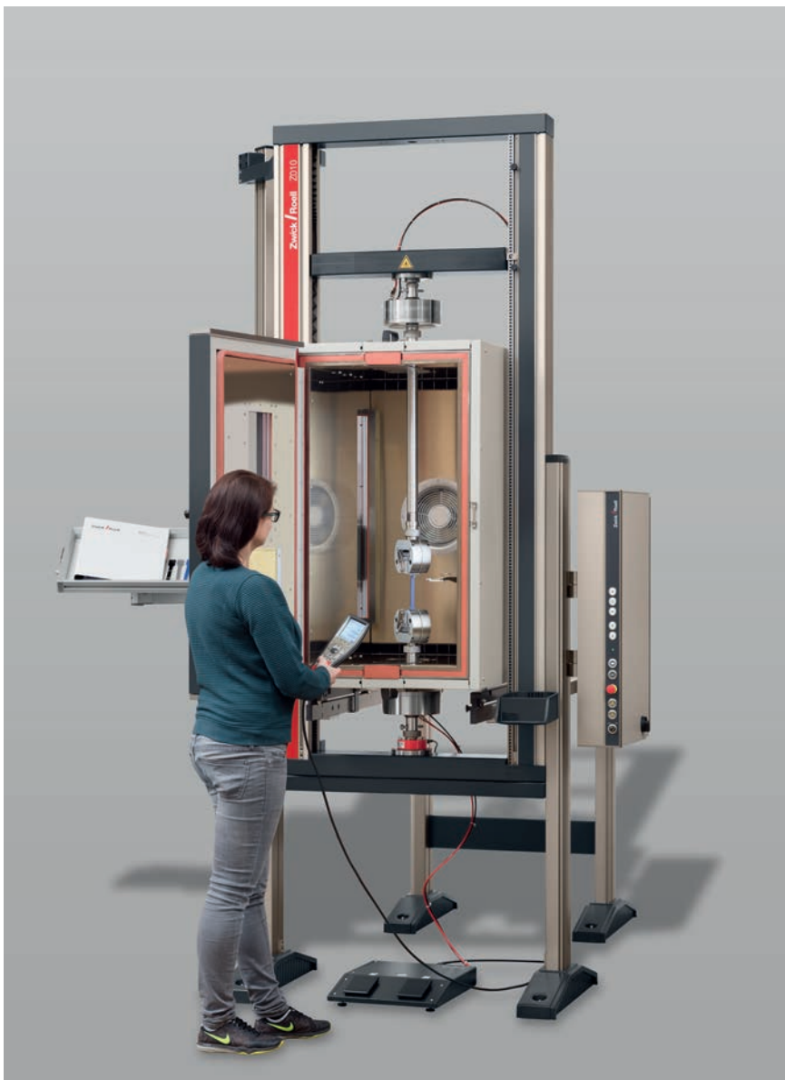
Bild 1: AllroundLine Prüfmaschine mit Temperiervorrichtung in Prüfposition. Die Längenänderungsmessung erfolgt durch einen seitlichen Schlitz.
