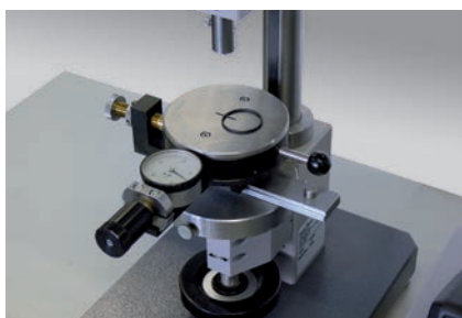
Bild 2: Härteprüfung an O-Ringen
