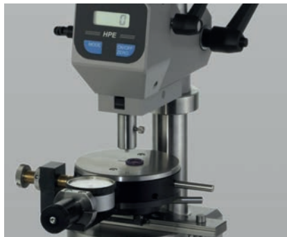
Bild 6: IRHD Härtemessung an einem O-Ring
