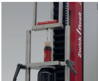
Bild 6: Ausziehversuche an Flaschenkorken
