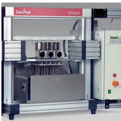
Bild 1: Das HDT/Vicat 3- bzw. 6-300 A verfügt über einen integrierten Wärmetauscher und ist mit einer Badgröße für drei oder sechs Messstationen ausgestattet.
