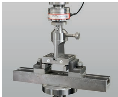
Bild 4: Einfacher Umbau von Zug auf Biege durch mechanische Einschübe und Lehren
