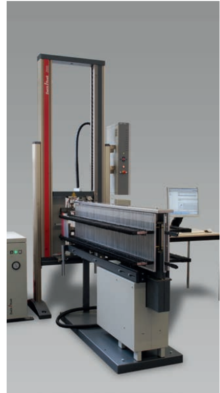
Bild 3: 'roboTest F' zur automatischen Probenzuführung von Folien
