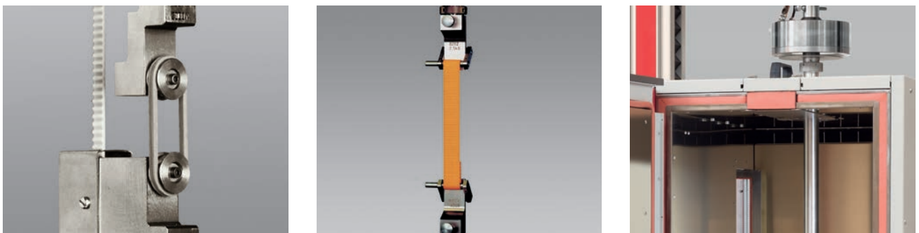
Bild 3: Schraub-Probenhalter, parallel klemmend für dünne und feste Werkstoffe in verschiedenen Zugkraftbereichen.
