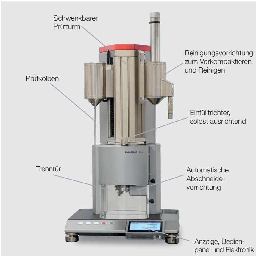
Bild 2: Das Aflow ist ein sehr robust gebautes Fließprüfgerät mit hohem Automatisierungsgrad für exzessive Nutzung bei geringstem Bedienerinfluss.
