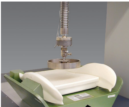
Bild 3: Eindruckhärte an Formschäumen (DIN 53579-1)
