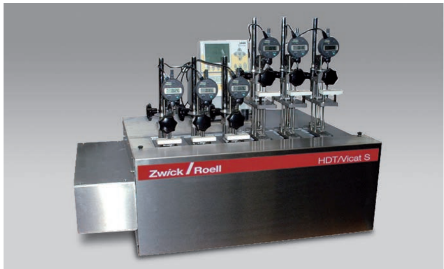
Bild 3: Das HDT/Vicat 6-300 S verfügt über ein Magnetventil zur Steuerung der Kühlung. Dieses Gerät kann mit 1 bis 6 Messstationen ausgestattet werden.
