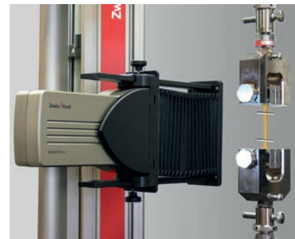
Bild 5: videoXtens HP für optische Längen- und Querdehnungsmessung
