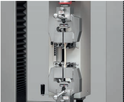
Bild 2: Zugversuch, z.B. nach ASTM D 638 (Qualitätsüberwachung)
