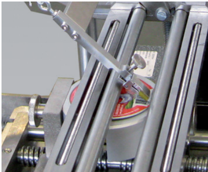
Bild 2: Prüfung der Siegelnaht an einem Joghurtbecher. Der Abzugswinkel bleibt konstant.
