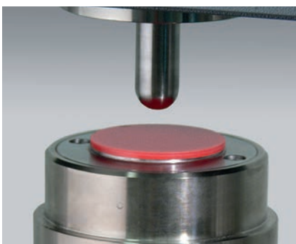
Bild 4: Durchstoversuch nach ISO 6603-2 mit Kraft-Weg-Aufzeichnung
