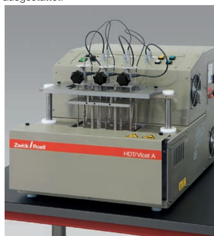
Bild 2: Das Allroundgerät HDT/Vicat 3- bzw. 6-300 A ist mit einer Hebebühne ausgestattet. So kann die gesamte Prüfung automatisch ablaufen. Es ist mit einer Badgröße für drei oder sechs Messstationen ausgestattet.
