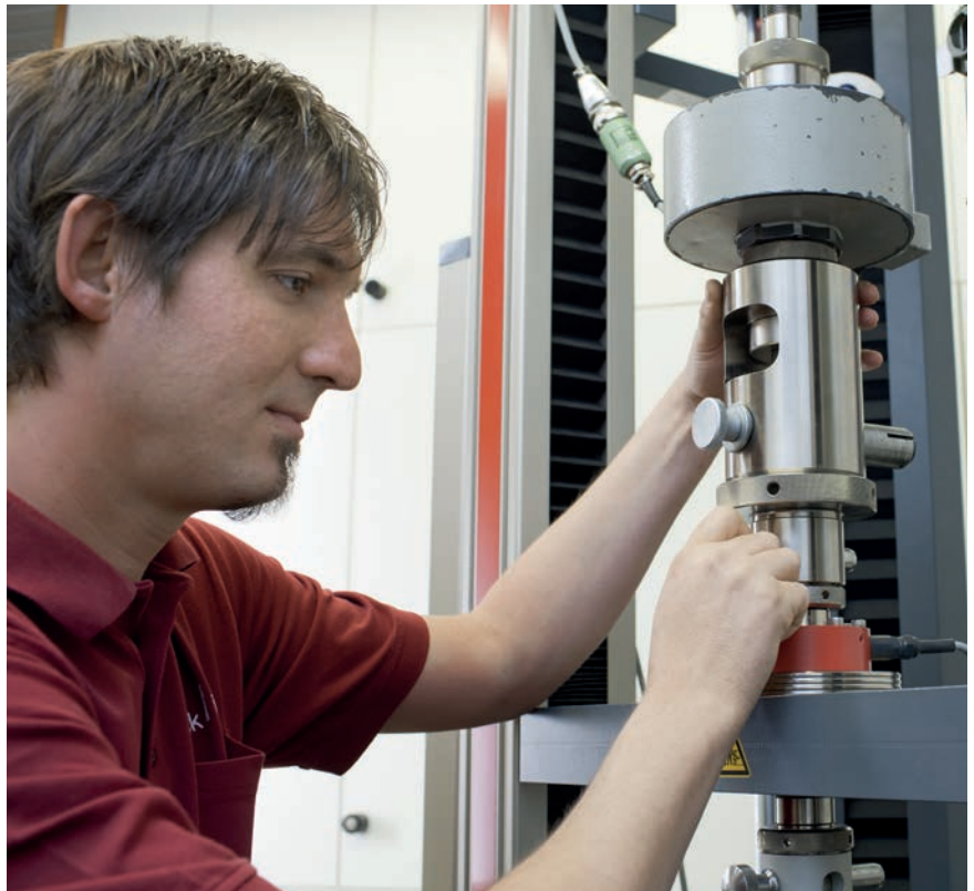
Bild 2: Jeder Kraftaufnehmer erhält eine ZwickRoell-Werkskalibrierung sobald er an einer Prüfmaschine zum Einsatz kommt.
