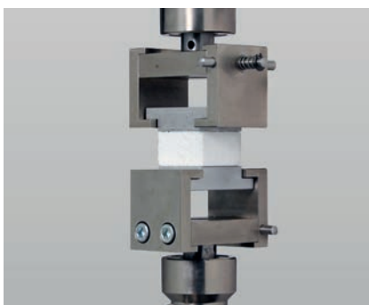
Bild 4: Zugversuch senkrecht zur Plattenebene nach EN 1607
