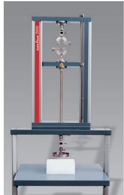
Bild 2: Prüfung von Schaumteilen im dritten Arbeitsraum unterhalb des Lastrahmens
