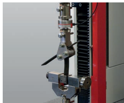
Bild 5: Rollenschälversuch nach ISO 4578
