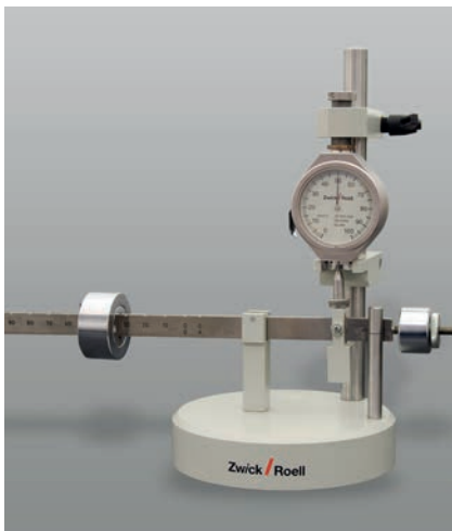
Bild 1: In der Kontrolleinrichtung werden Shore A und D Geräte überprüft.
