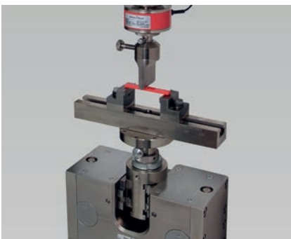
Bild 4: Einfacher Umbau von Zug auf Biege durch mechanische Einschübe und Lehren
