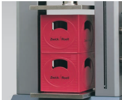
Bild 1: Bestimmung der Stapelfähigkeit von Bechern und Getränkekisten
