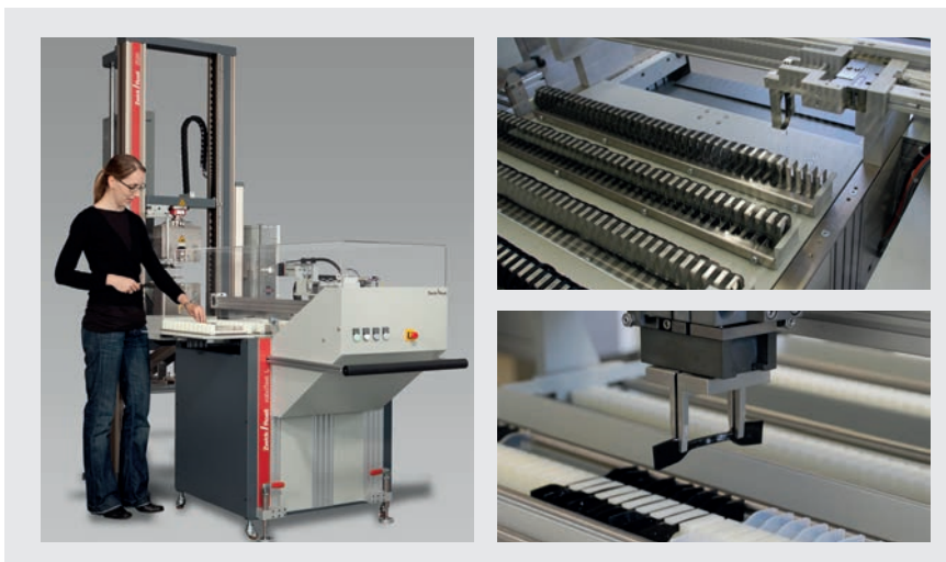
Bild 1: 'roboTest L' Zug- und Biegeprüfungen an Kunststoffen und Gummi. Das große Probenmagazin erlaubt einen Betrieb über Nacht und am Wochenende.
