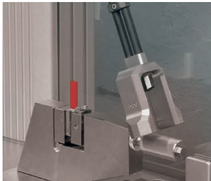
Bild 1: Konventionelle Schlagprüfungen: Links Charpy, rechts Izod
