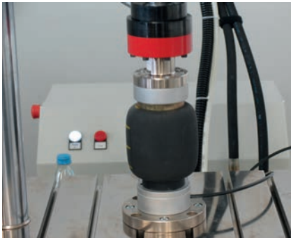
Bild 3: Ermüdungsprüfung von Dämpfern...
