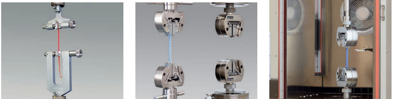
Bild 4: Spezielle Probenhalter für bestimmte Werkstoffe und Probenformen: Zangenspannkopf, Ringprüfeinrichtung, Umlenk-Probenhalter
