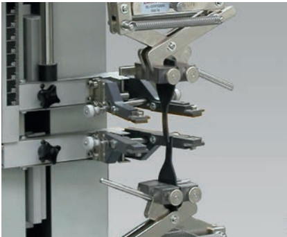
Bild 1: Zugversuch nach ISO 37
