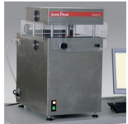
Bild 3: Beim Vicat-Dry sorgt das ölfreie Messprinzip für ein sauberes Arbeiten.
