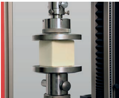
Bild 3: Druckversuch nach ISO 844 links ohne und rechts mit direkter Wegmessung
