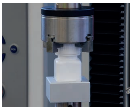
Bild 7: Funktionsprüfung von Sicherheits-Schraubverschlüssen
