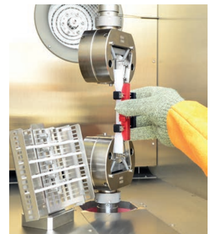
Bild 3: Einschübe zum Aus- und Einfahren ohne Ausbau der Probenhalter
