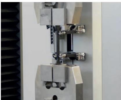
Bild 4: Zugversuch nach ISO 6259-1: Je nach Wandstärke kommen verschiedene Probenformen zum Einsatz
