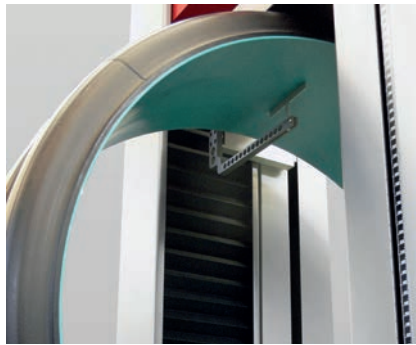
Bild 1: Messung der Ringsteifigkeit nach ISO 9969: Die Ringverformung wird am Innendurchmesser gemessen.
