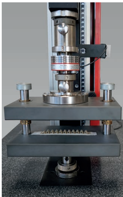
Bild 1: Corrugated medium test (CMT-Versuch)
