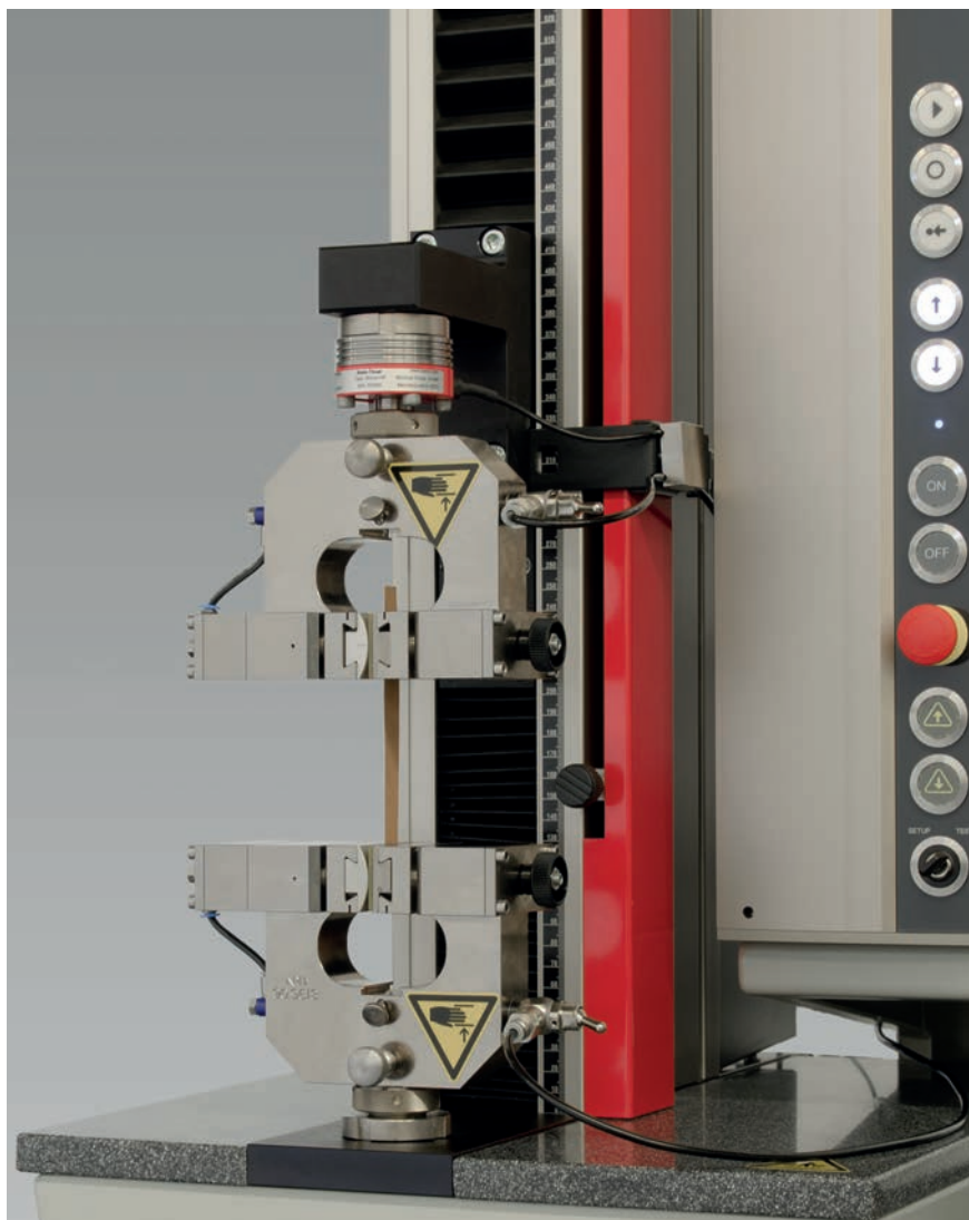
Bild 1: Zugversuch an Papier im trockenen Zustand
