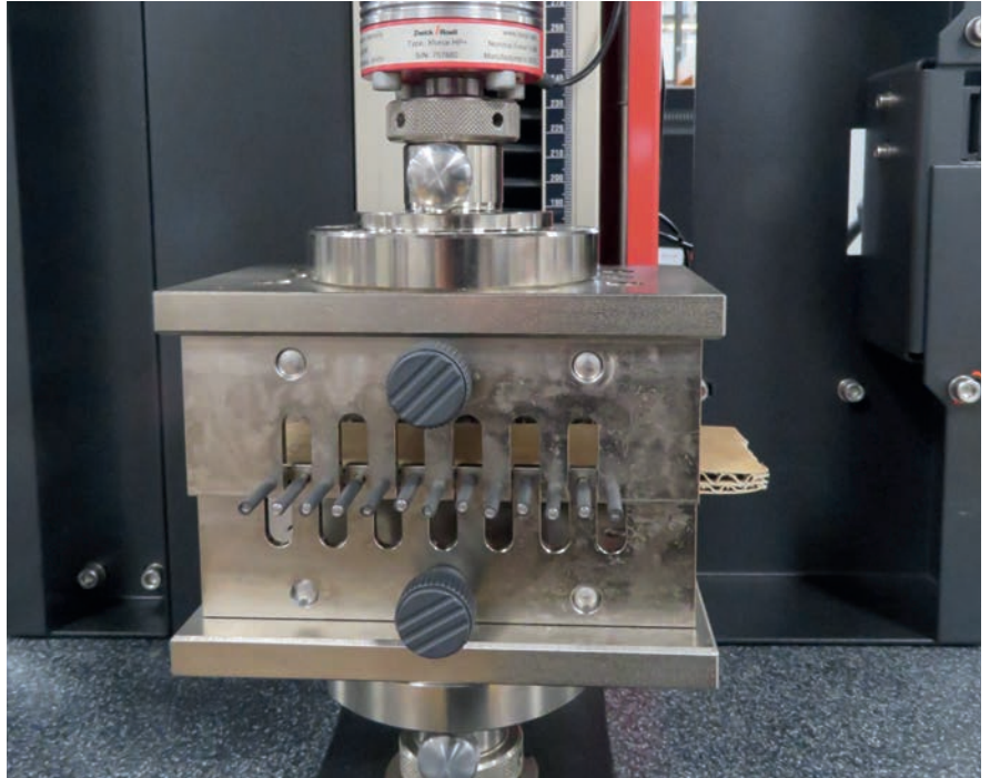
Bild 2: Pin adhesion test
