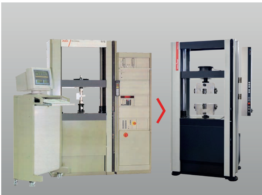
Bild 1: Modernisierung einer statischen Material-Prüfmaschine mit testControl II
