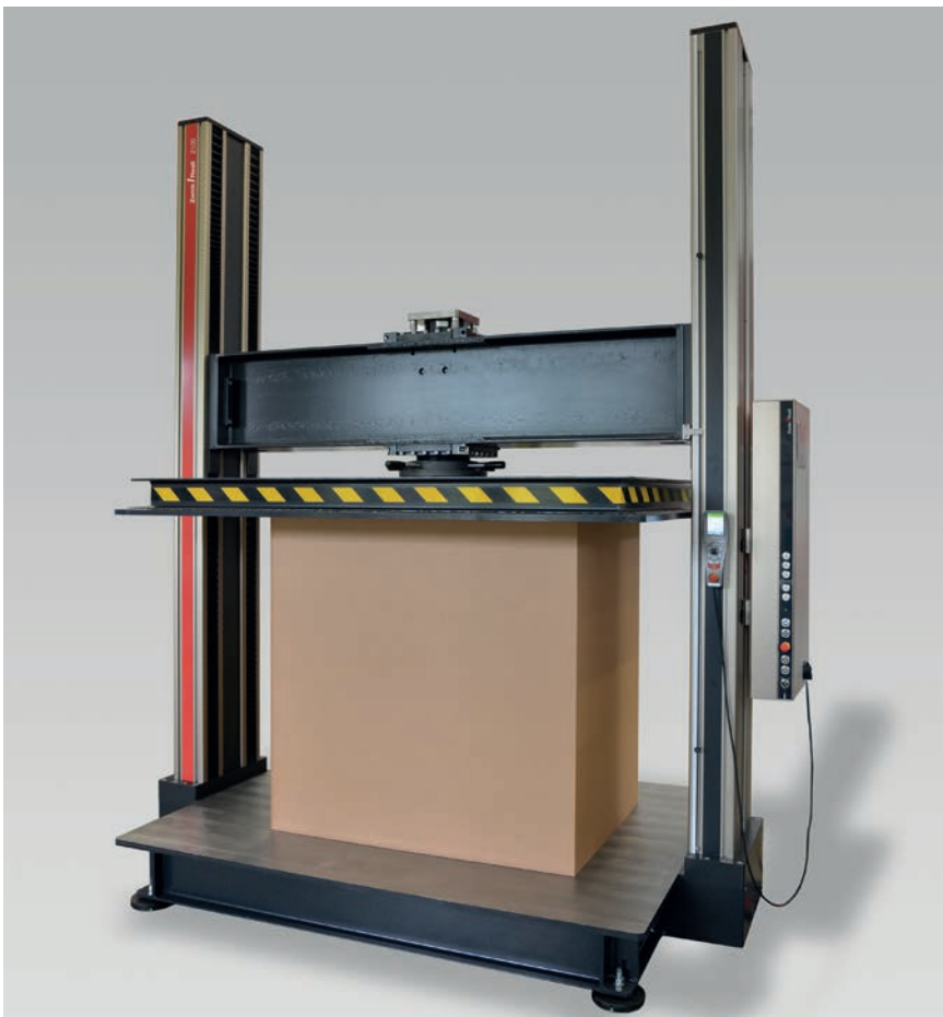
Bild 1: Schachtel- und Stapelstauchversuch
