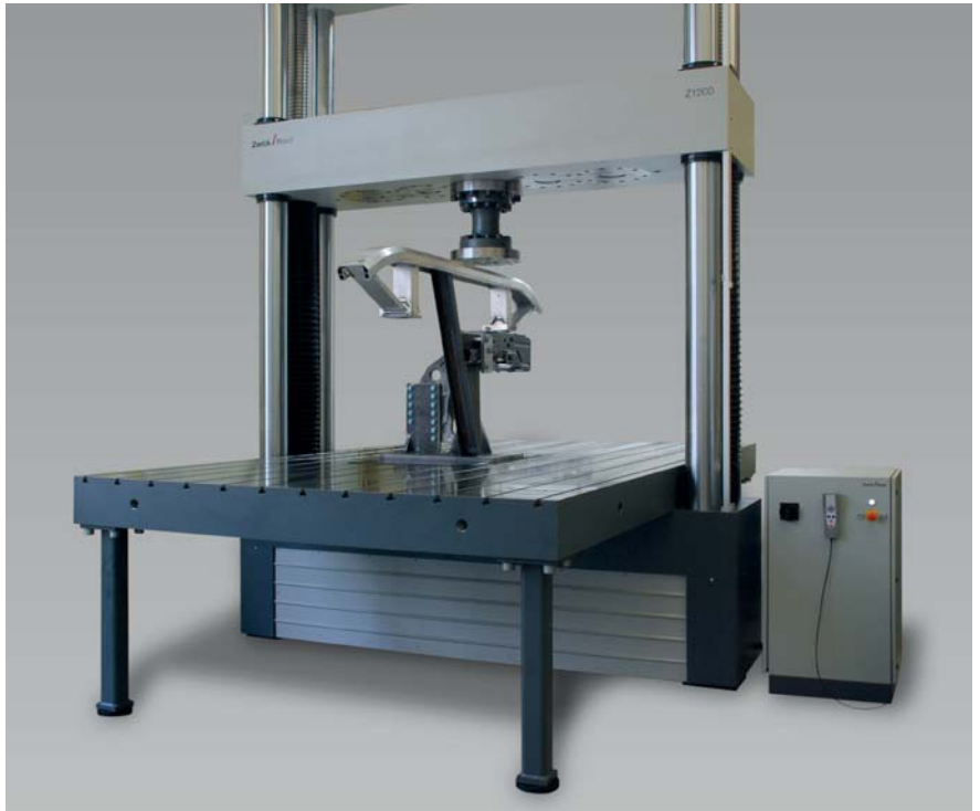
Bild 2: Flexibles Aufspannfeld zur Prüfung unterschiedlicher Karosserie- und Strukturelemente
