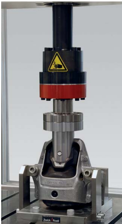
Bild 1: Einachsige Ermüdungsprüfung eines Motorlagers
