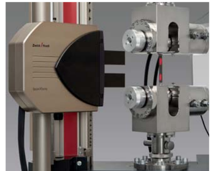
Bild 3: Probenhalter und Extensometer können jederzeit nachgerüstet werden
