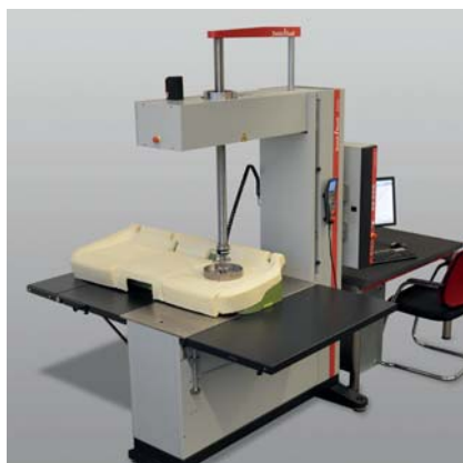
Bild 1: Ermittlung der Eindruckhärte von vorgeformten Weichschäumen
