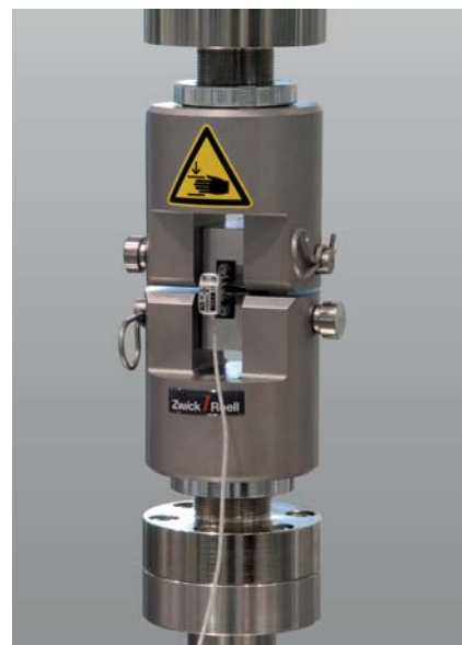
Bild 2: Ermittlung der Bruchzähigkeit K_{Ic}
