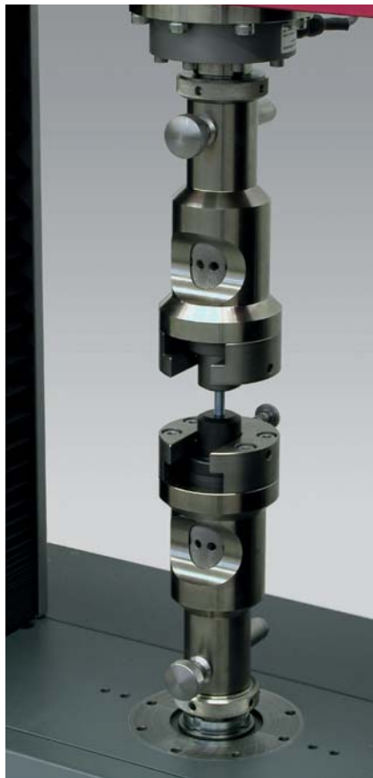
Bild 1: Statischer Zugversuch an Schrauben
