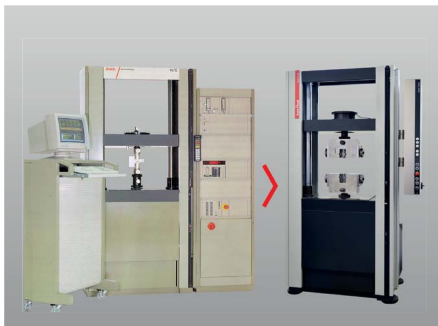
Bild 1: Modernisierung einer statischen Prüfmaschine mit testControl II
