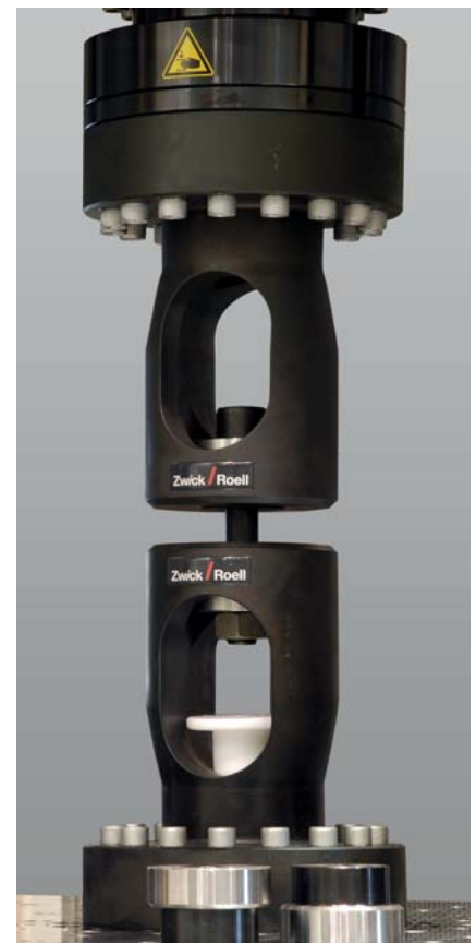
Bild 2: Ermüdungsprüfung an Schraubverbindungen mit dem Vibrophore
