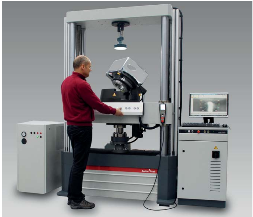
Bild 1: Blechumformprfung mit videoXtens
