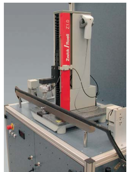
Bild 4: Prüfung von Dichtungs-Sensoren
