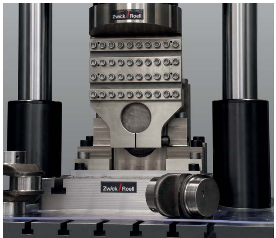
Bild 2: Kurbelwellen-Segment unter dynamischer Belastung in einem Vibrophore
