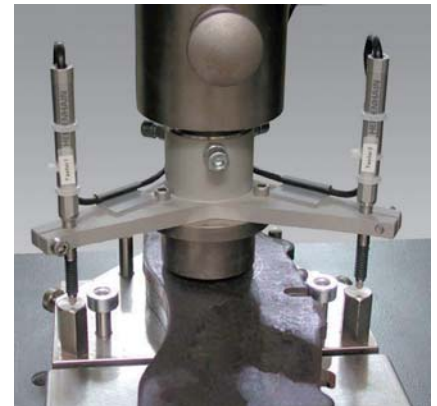
Bild 5: Druckprüfung an Bremsbelägen
