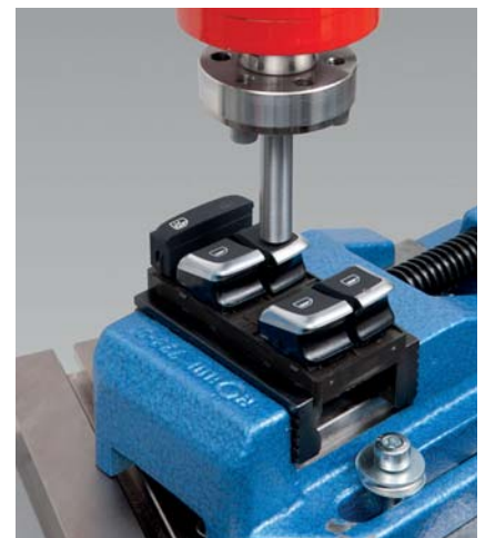
Bild 2: Funktionsprüfung an einem Fensterheberschaltetelement
