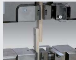
Scherzugversuch an Holzverbindung
