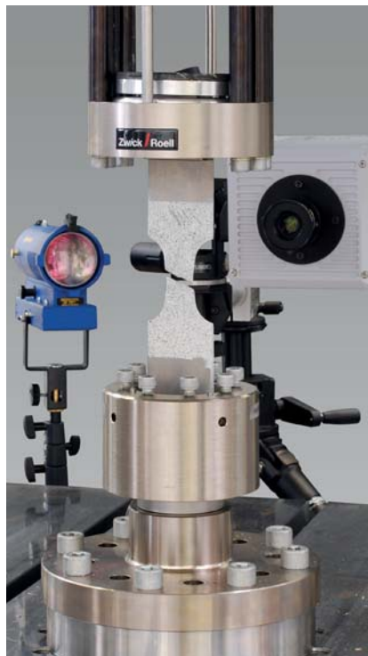
Bild 2: Schnellzerreiversuch mit einer Prfgeschwindigkeit von bis zu 20 m/s
