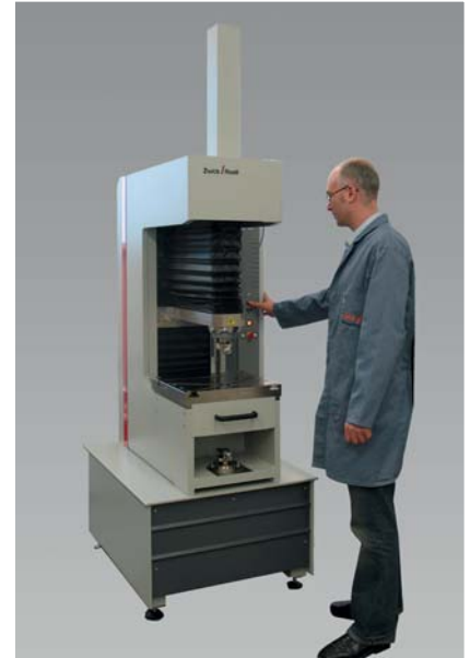
Bild 5: Ausdrückversuch einer Nietverbindung
