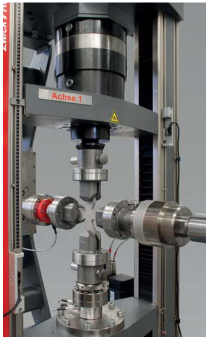
Bild 2: Biaxiale Prüfmaschine mit überlagerter Torsion
