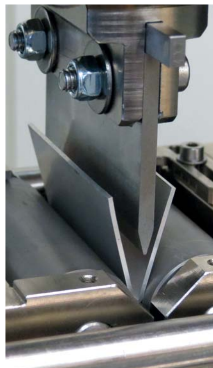
Bild 3: Plttchen-Biegeversuch nach VDA 238-100
