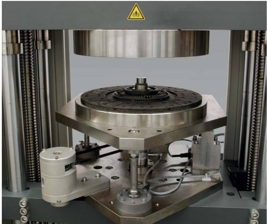
Bild 1: Ermittlung von Anpresskraft und -weg sowie Ausrückkraft und -weg von Reibungskupplungen
