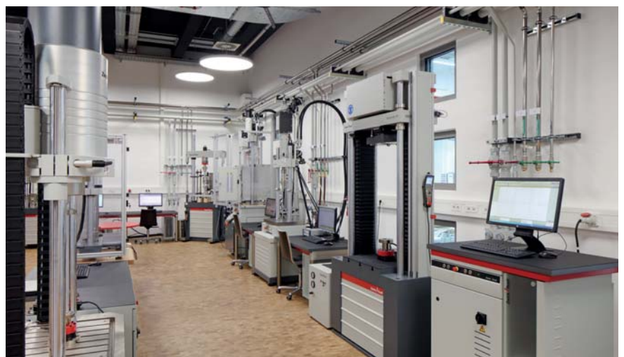
Bild 2: Ein Teil der dynamischen Prüfmaschinen im ZwickRoell Labor für Material- und Bauteilprüfung
