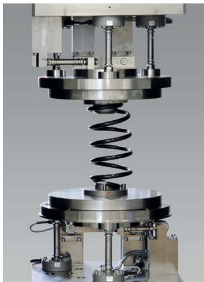
Bild 1: Mehrkanalige Prüfung an einer Fahrwerksfeder
