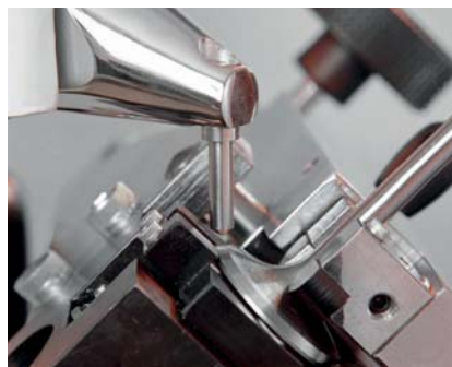
Bild 5: Härteprüfung an Ventilen
