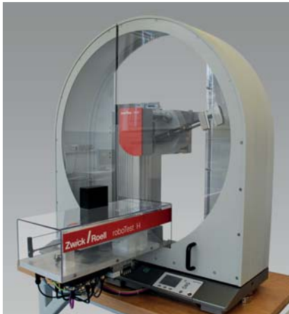
Bild 1: Pendelschlagwerk HIT50 P mit automatischer Probenzuführung
