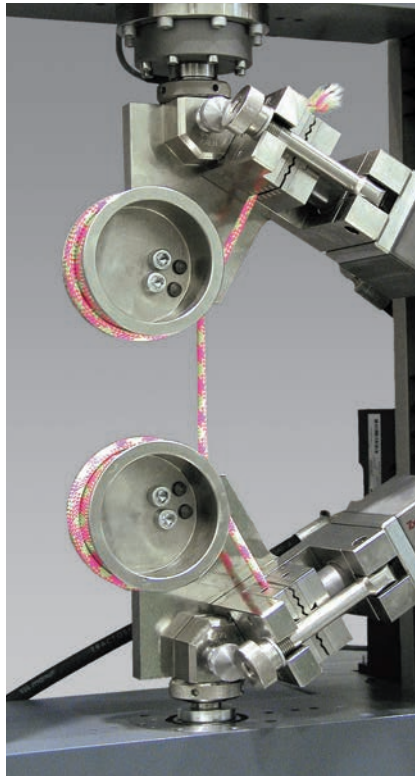
Bild 1: Zugprüfung an Seilen
