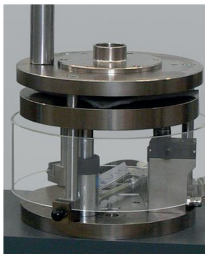
Bild 2: Stempeldurchdruckversuch (CBR Versuch)
