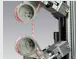
Zugversuch an Textilien
