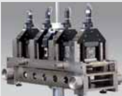
Ermüdungsprüfung an Asphaltproben
