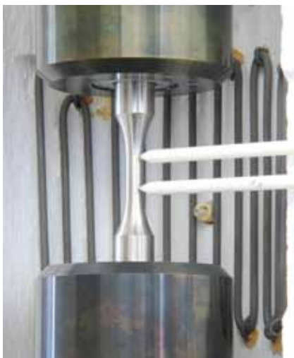
Bild 1: LCF-Versuch unter Hochtemperatur mit angesetztem Dehnungsaufnehmer
