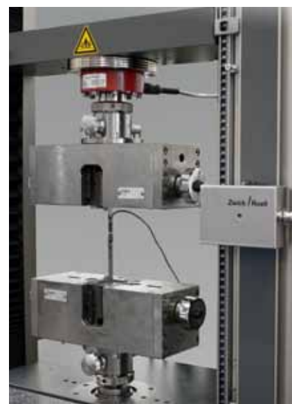
Bild 5: Direkter Anschluss von DMS an testControl II über eine Vorschaltbox
