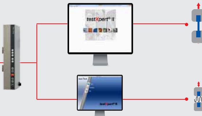
Elektromechanische Prüfmaschine für quasistatische Versuche und Anwendungen mit speziellen regelungstechnischen Anforderungen
