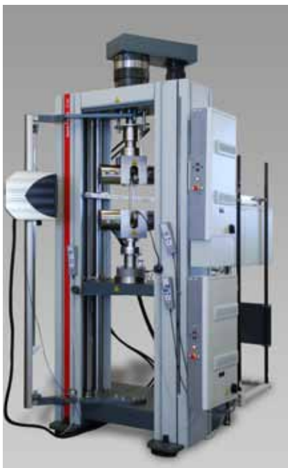
Bild 1: Tension-Torsion Prüfungen mit optischer Dehnungsmessung
