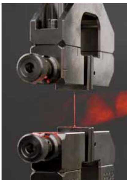
Bild 2: Berührungslose Dehnungsmessung mit dem laserXtens, geeignet auch für Mikroproben.
