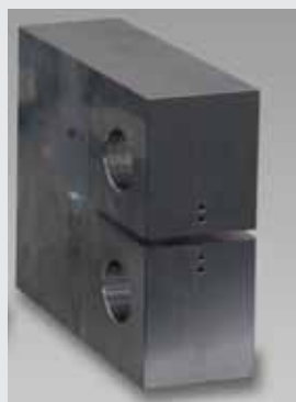
Bild 3: CT-Probe, Anschwingen der Probe und Fahren bis Bruch mit testXpert Research
