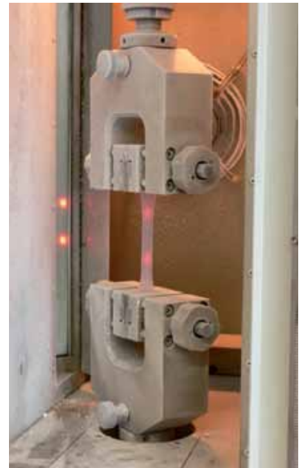
Bild 3: Zugversuch bei - 70 °C mit optischer Dehnungsmessung
