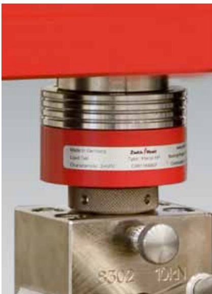
Bild 1: Kraftaufnehmer der Xforce Baureihe mit Mehrfach Biegebalken Mitte
