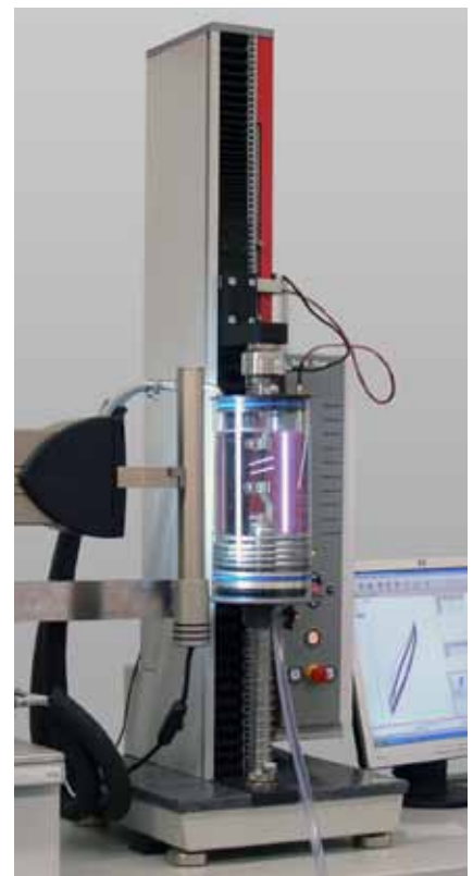
Bild 4: Zugversuch bei 37 °C (+ Mediumbad) mit videoXtens
