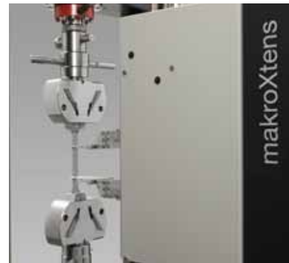
Bild 3: Mechanisch messend, automatisch ansetzend: der makroXtens
