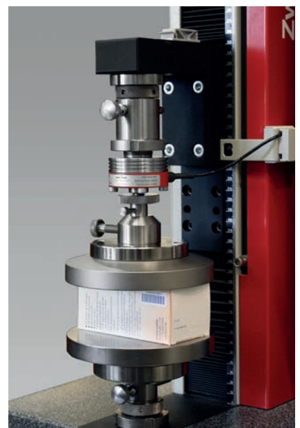
Bild 3: Box-Crush-Test an Medikamenten-Verpackungen
