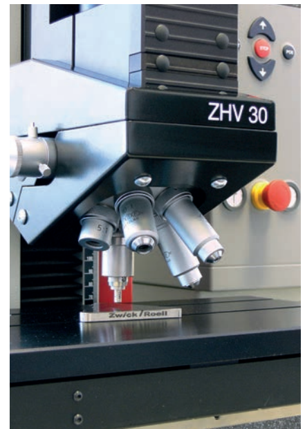
Bild 3: Härteprüfung an Dentalkeramik
