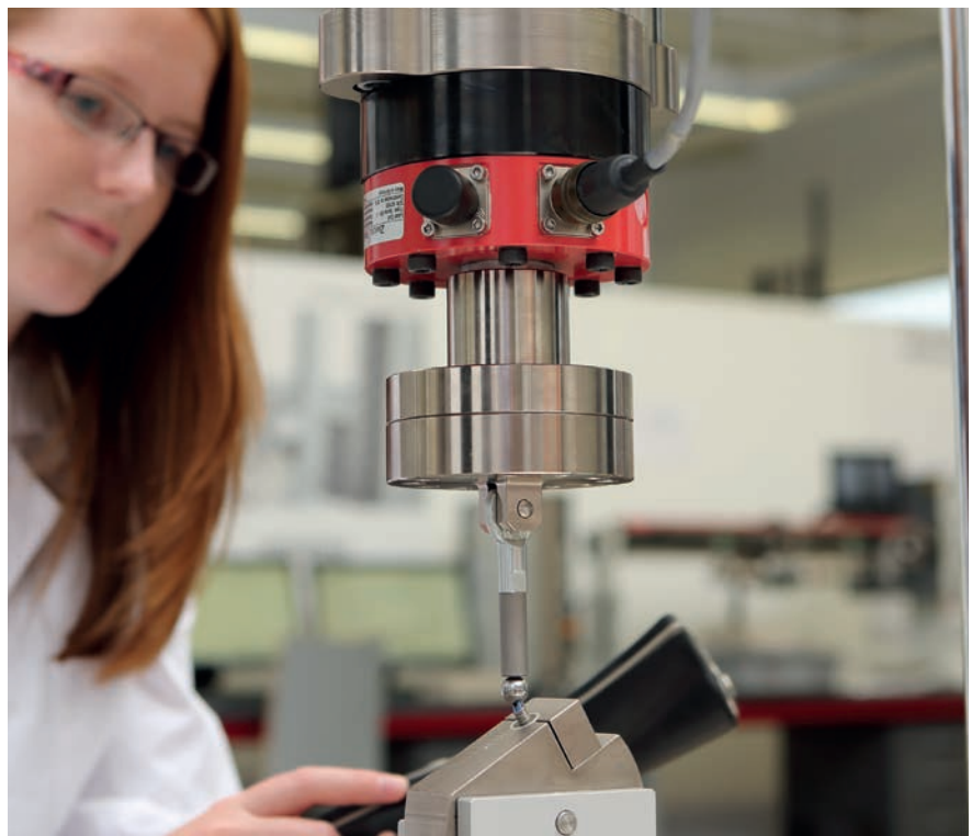
Bild 1: Ermüdungsprüfung an Dentalimplantaten
