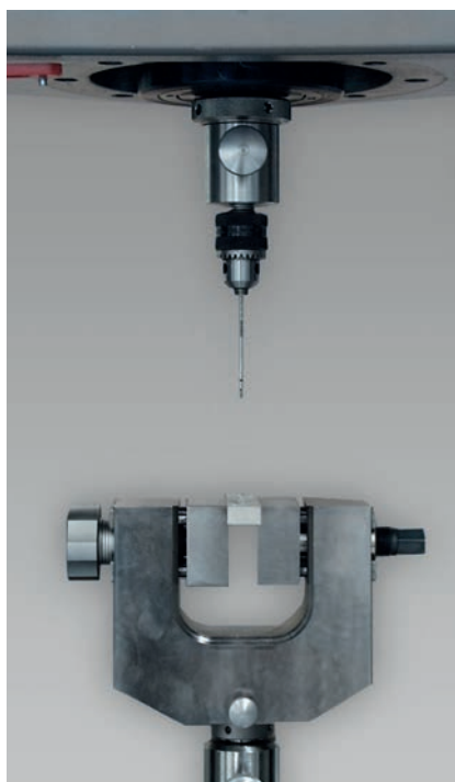
Bild 2: Eindringversuch eines Knochenbohrers
