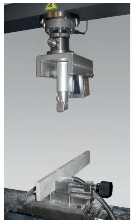
Bild 3: Druckversuch an Sagittalsägeblatt
