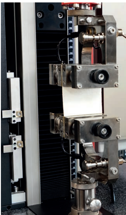
Bild 1: Zugversuch an medizinischen Textilien
