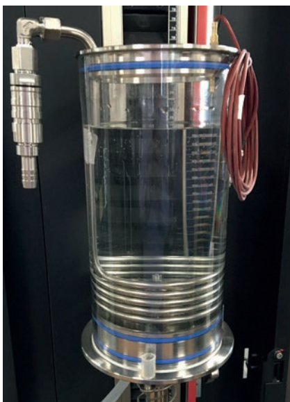
Bild 1: Mediumbehälter mit Temperiereinheit
