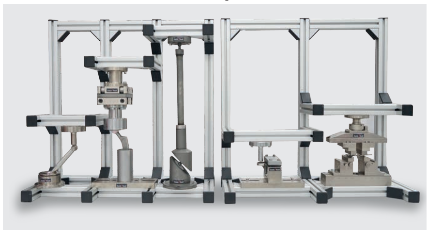
Bild 3: Unterschiedliche Probenhalter und Prüfwerkzeuge für die Biomechanik Prüfung
