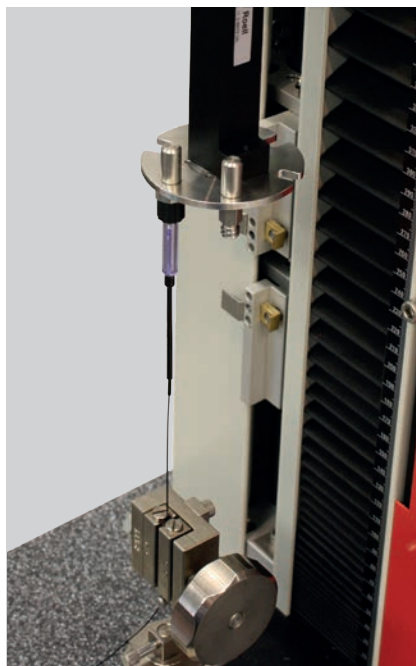
Bild 2: Zugprüfung an Kathetersystemen
