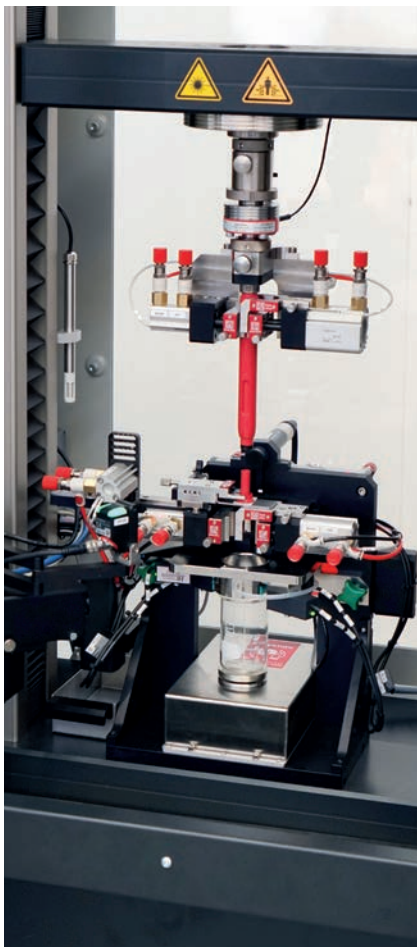
Bild 1: Multiple Prüfungen an Autoinjektoren
