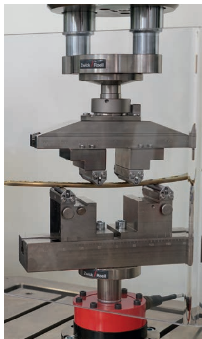
Bild 2: Biegeprüfung an Osteosyntheseplatte
