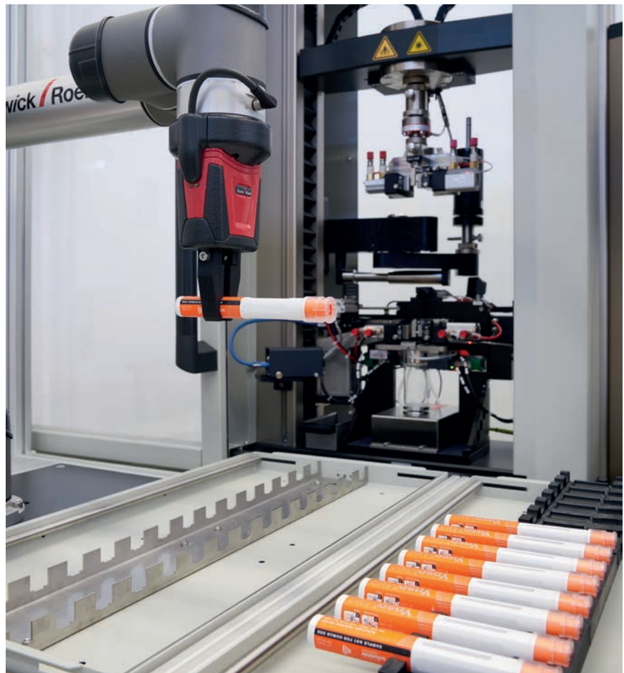
Bild 2: Prüfsystem mit vollautomatischer Probenzuführung
