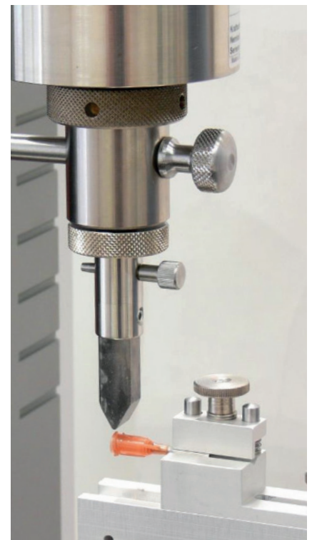
Bild 4: Biegeprüfung an Nadeln
