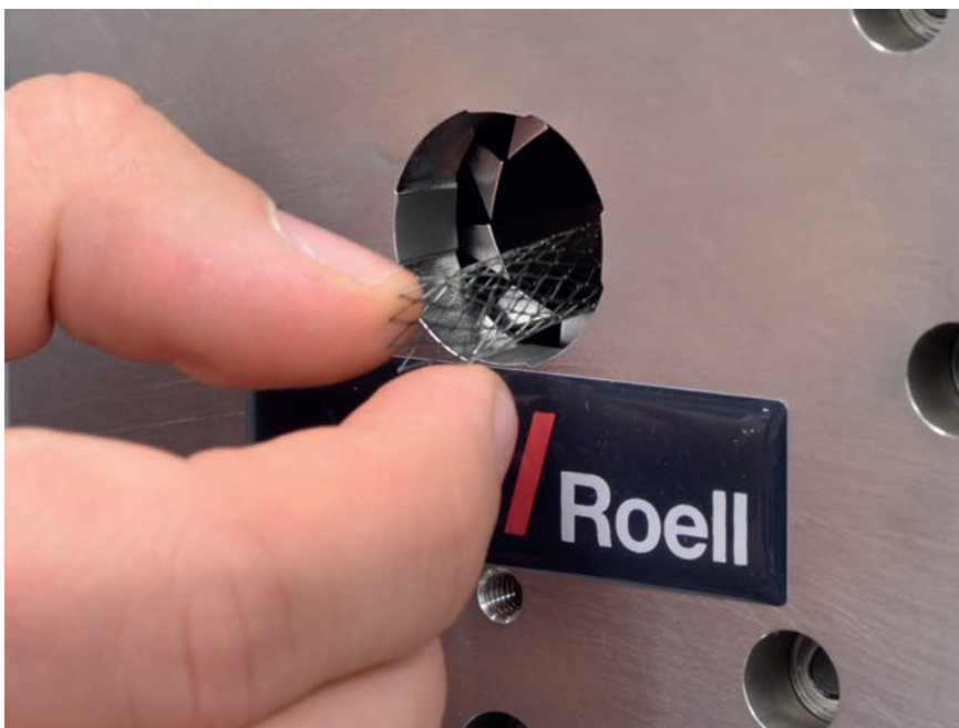
Bild 1: Radialdruckprüfung an Stents
