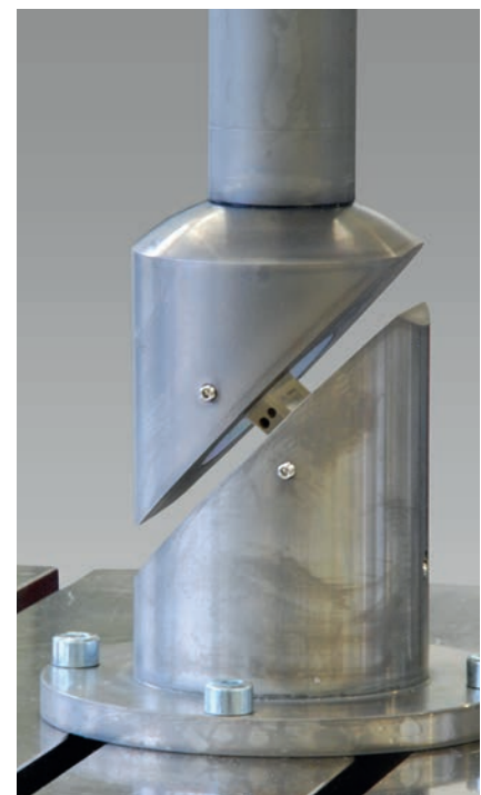
Bild 2: Torsionsprüfung an Wirbelkörperimplantat
