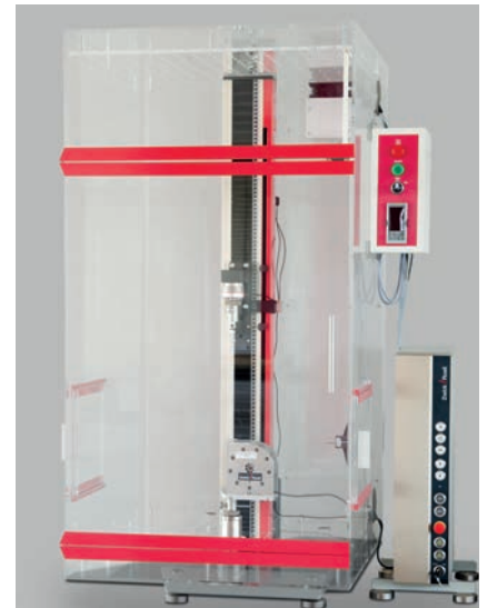
Bild 3: Temperierkammer integriert mit einer Material-Prüfmaschine
