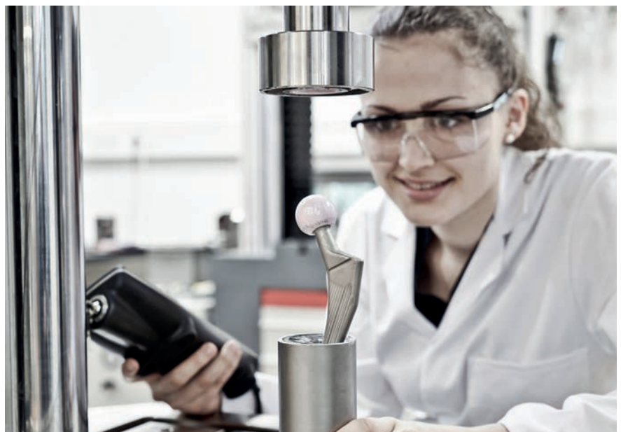
Bild 1: Ermüdungsprüfung an Hüftprothese
