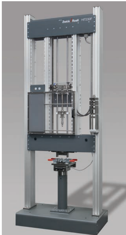
Bild 1: Fallwerk HIT 230F mit Zubehör für die CAI-Vorschädigung
