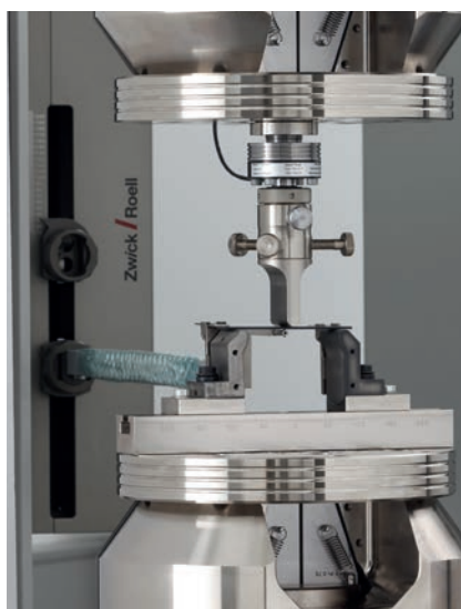
Bild 3: makroXtens mit Biegeföhler für 3- und 4-Punkt Biegeversuche
