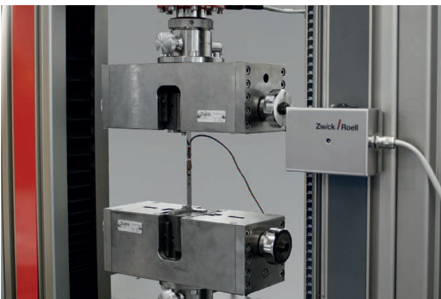
Bild 4: Direkter Anschluss von DMS an testControl II über eine fertig konfigurierte Vorschaltbox
