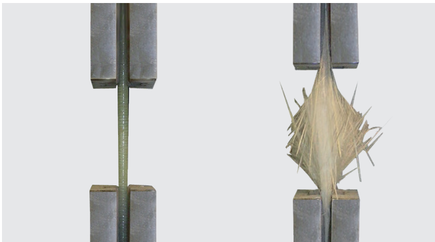
Bild 1: Pultrudiertes GFK-Rundprofil, ohne Aufleimer eingespannt. Rechts: Gültige Faserbrüche im Bereich der freien Einspannlänge durch sanfte Spannkrafteinleitung.
