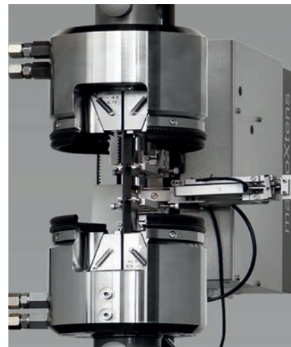
Bild 4: makroXtens mit Breitenänderungsaufnehmer für Zug- oder In-Plane Shear (IPS) Versuche bei RT
