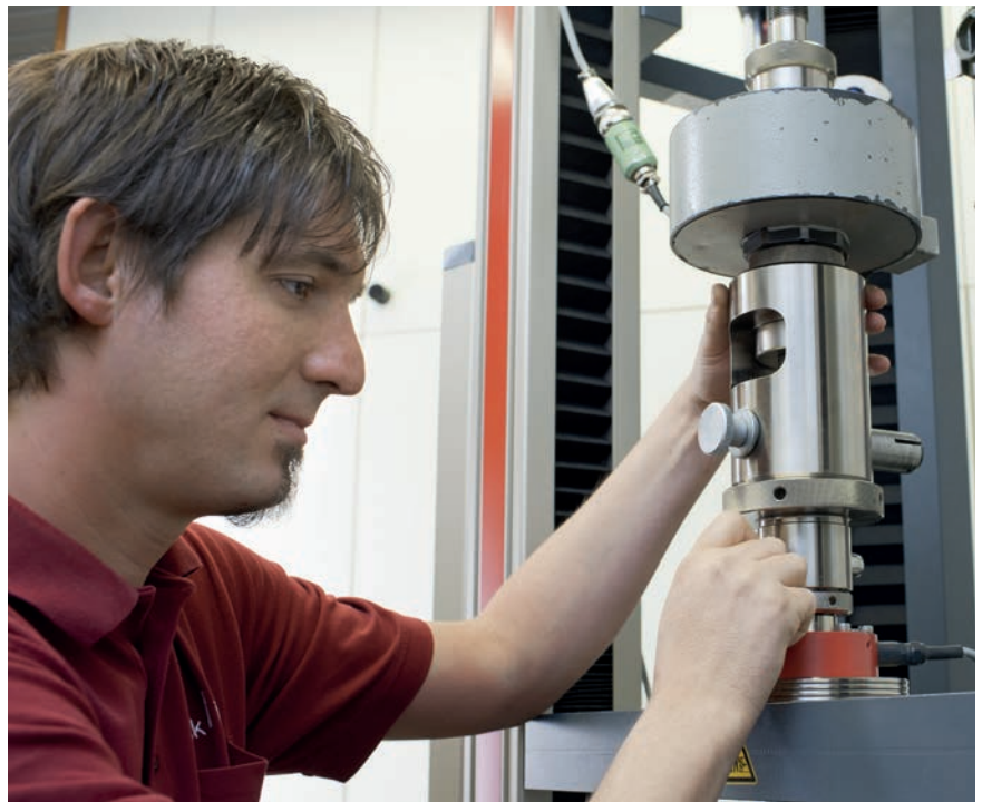
Bild 2: Jeder Kraftaufnehmer erhält eine ZwickRoell-Werkskalibrierung sobald er an einer Prüfmaschine zum Einsatz kommt.
