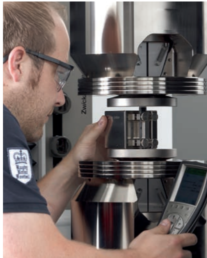
Bild 2: End-loading Druckvorrichtung nach prEN 2850 und ASTM D 695 (Boeing modifiziert). Der Stützblock wird mit Anschlägen zur Druckachse zentriert.
