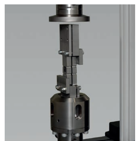
Bild 5: OHC und FHC Druckversuche nach ASTM erfordern eine Knickstütze, die sowohl im shear loading mit hydraulischen Probenhalter, als auch im end-loading zwischen Druckplatten verwendet wird.
