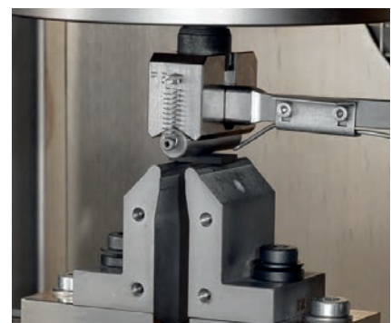
Bild 5: Befestigung eines Temperatursensors nahe am Probekörper
