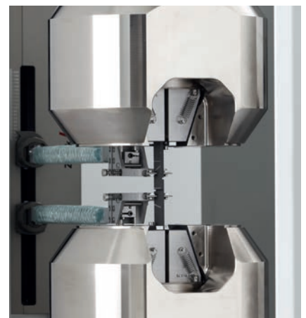
Bild 1: Zur Prüfung von Laminaten stehen zentrisch schließende Keilprobenhalter, seitlich verstellbare Keilschraub-Probenhalter, sowie hydraulische, parallel schließende Körper-über-Keil-Probenhalter mit breiter Backenauswahl zur Verfügung.
