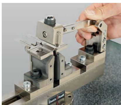
Bild 4: Einstelllehre mit variablem Auflagerabstand
