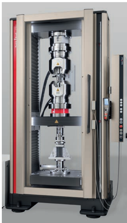
Bild 2: Im Druckversuch wird die Restdruckfestigkeit des Probekörpers und damit seine Schadenstoleranz bestimmt. (unten: Druckeinrichtung nach ASTM, DIN, Boeing, oben: Druckeinrichtung nach ISO, EN, Airbus.)
