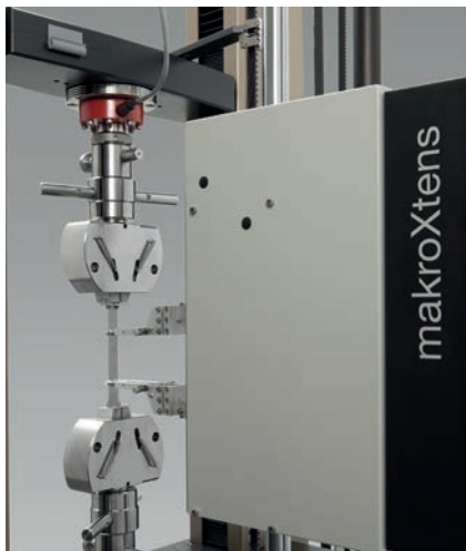
Bild 1: Mechanisch messend, automatisch ansetzend: der makroXtens
