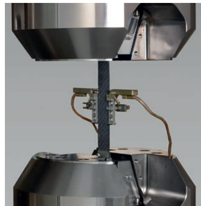
Bild 5: Axial messender Ansatz-Wegaufnehmer
