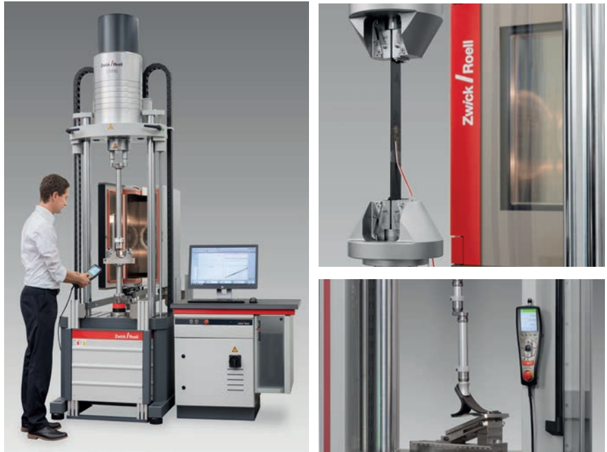
Bild 1: LTM 10 – Ermüdungsprüfung in verschiedenen Prüffarten im Lastbereich
