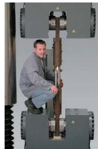
Fig. 4: Hydraulic grips 2000 kN
