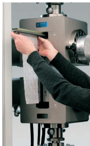
Fig. 3: Hydraulic grips 250 kN
