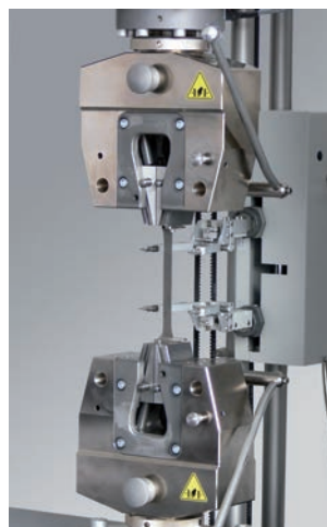
Fig. 3: Wedge grips 100 kN
