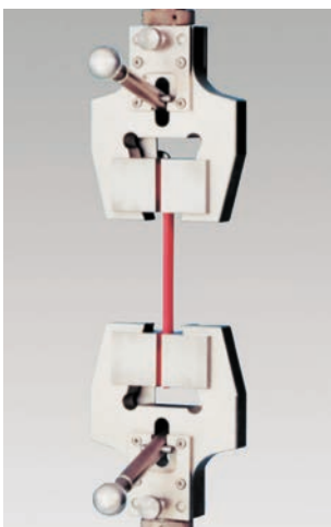
Fig. 1: Wedge grips 2,5 kN
