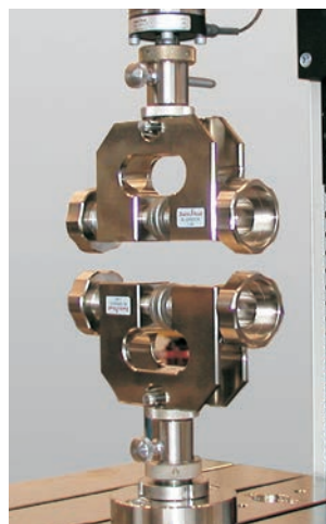
Fig. 3: Screw grips 2,5 kN
