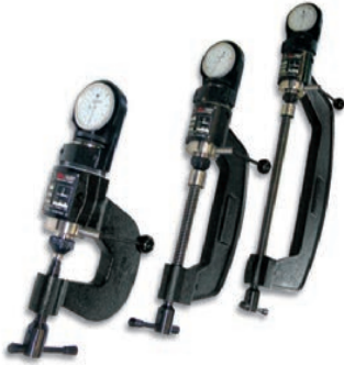
/ N4 – Duromètre portable de type serre joint
