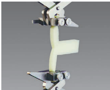
Fig. 2: Tear test ISO 8067
