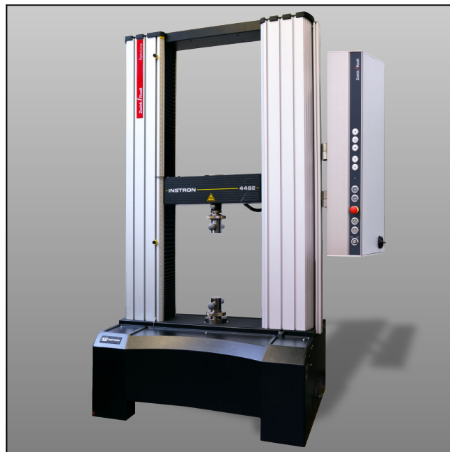
Modernisierte Instron 4482 (100 kN) mit ZwickRoell Technologie
