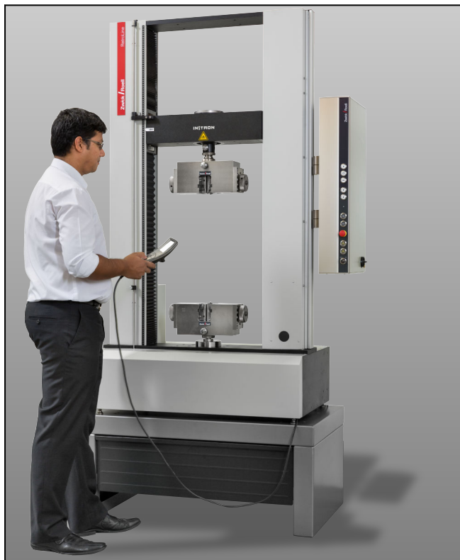
Instron 4204 (50kN) modernisiert und mit aktuellem ZwickRoell-Zubehör
