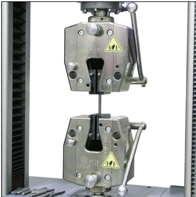
Keil-Probenhalter Typ 8402, Fmax 50 kN
