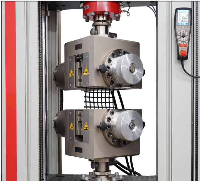
Hydraulik-Probenhalter Typ 8593, Fmax 250 kN
