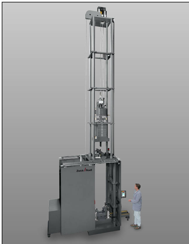
ZwickRoell Großfallwerk DWT40 mit 5 m Fallhöhe
