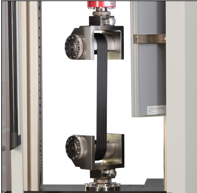
Walzen-Probenhalter Typ 8464, Fmax 50 kN, Walzen-/Klemmbreite 120 mm
