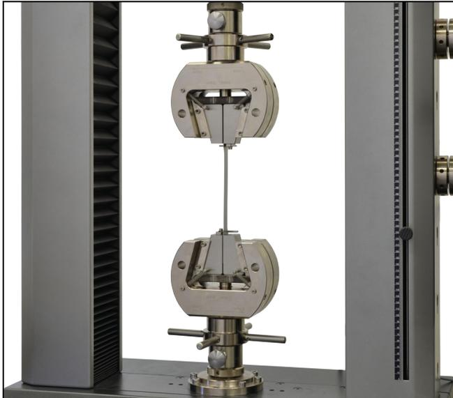
Keil-Probenhalter Typ 8404, Fmax 50 kN
