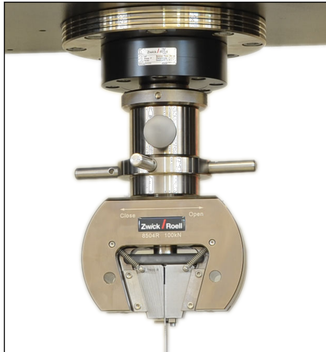
Keil-Probenhalter Typ 8504, Fmax 100 kN bis 250 °C
