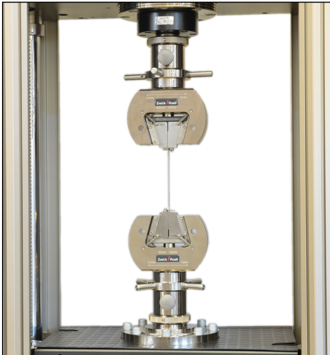
Keil-Probenhalter Typ 8504, Fmax 100 kN bis 250 °C
