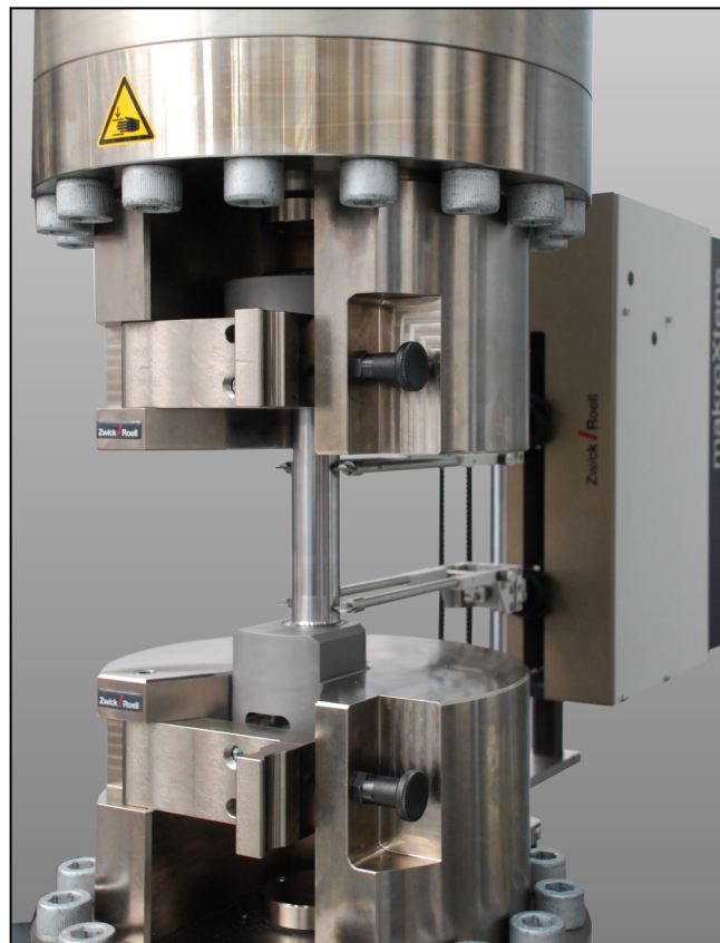
1200 kN Probenhalter mit makroXtens Extensometer an abgedrehter Schraube
