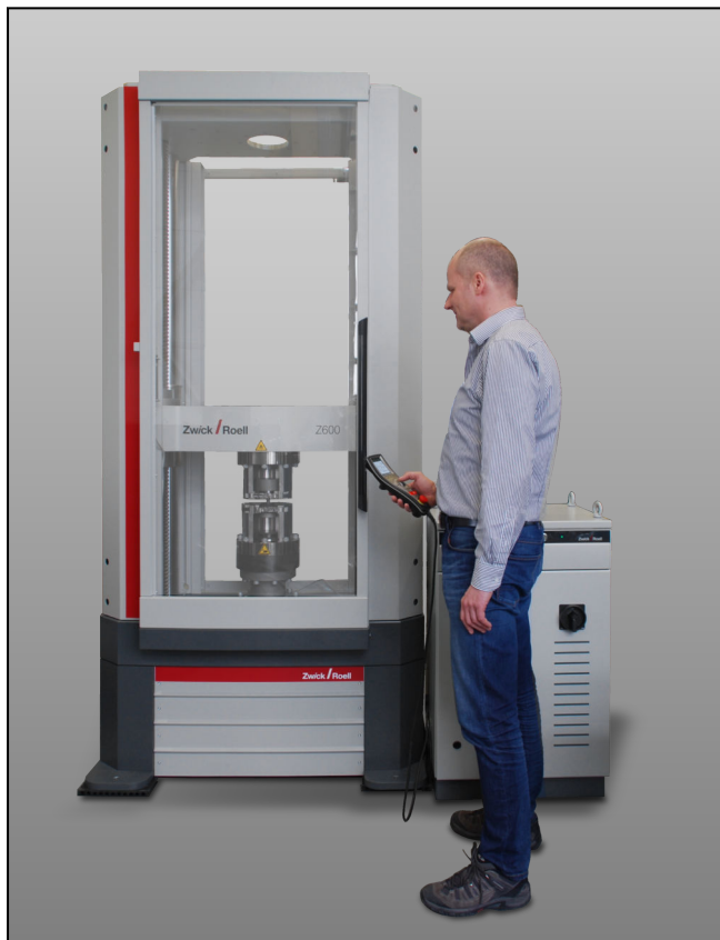
Z600E mit Probenhalter für Schrauben, Schulter- und Gewindekopfproben
