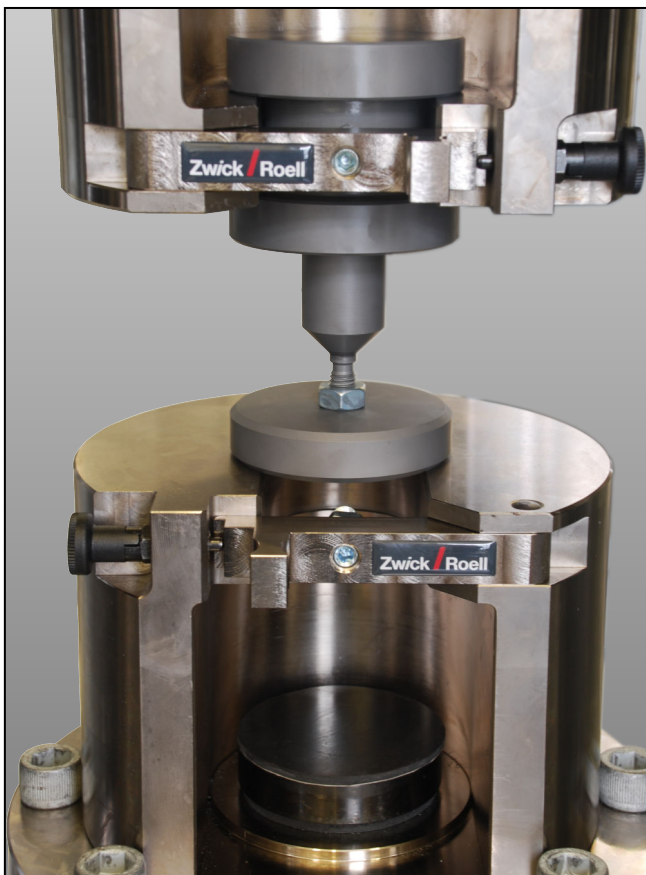
600 kN Probenhalter mit Prüfdorn und Matrize
