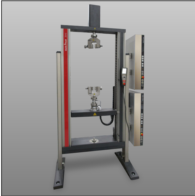
Tisch-Prüfmaschine mit Torsionsantrieb auf Kopftraverse
