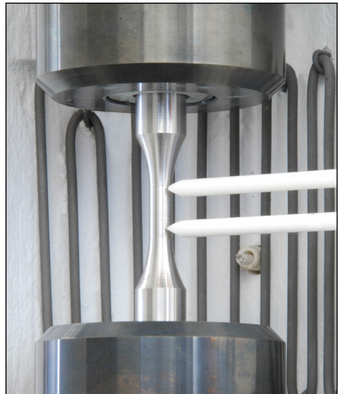
Probe mit Längenänderungsaufnehmer im Hochtemperatur-Ofen
