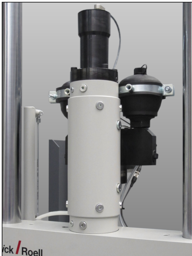
LH-Zylinder, Überkopfmontage in einem Prüfraum
