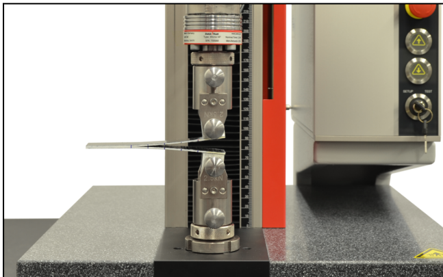
Vorrichtung zur G_{IC} -Prüfung an langfaserverstärkten Verbundwerkstoffen
