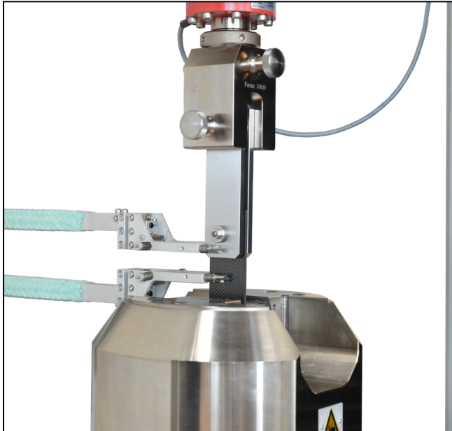
Lochleibungsvorrichtung nach AITM 1-009 mit Probenhalter zur Aufnahme der Lochleibungsvorrichtung
