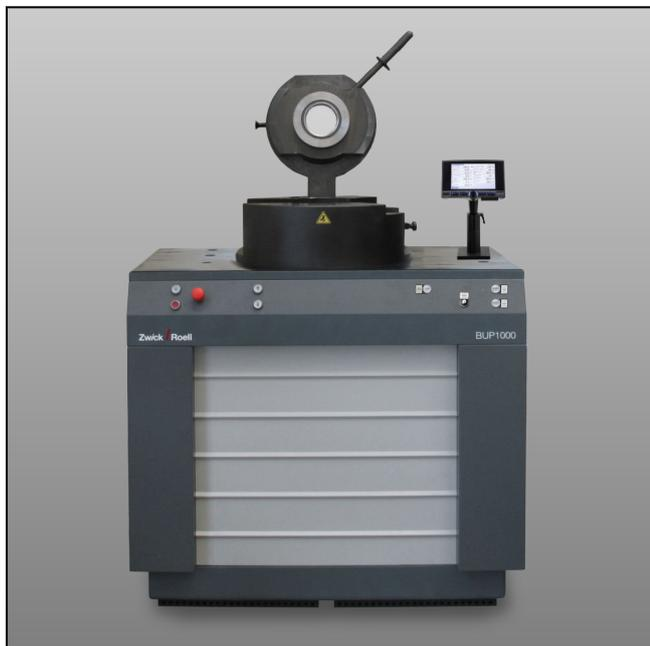
Blechumform-Prüfmaschine BUP 1000
