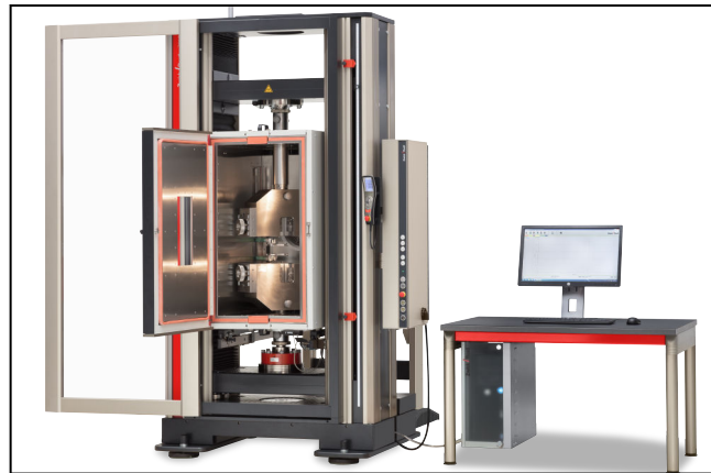
AllroundLine Z250 mit 600 mm breiter Temperierkammer
