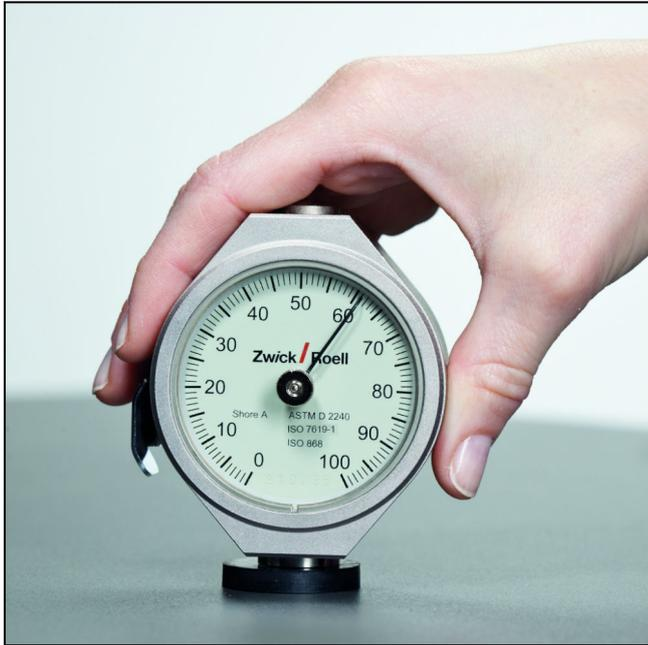
ZwickRoell 3115 Härteprüfgerät nach Shore A mit Schleppzeiger
