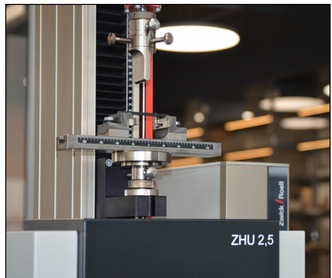
3-Punkt-Biege-Versuch an Kunststoffen
