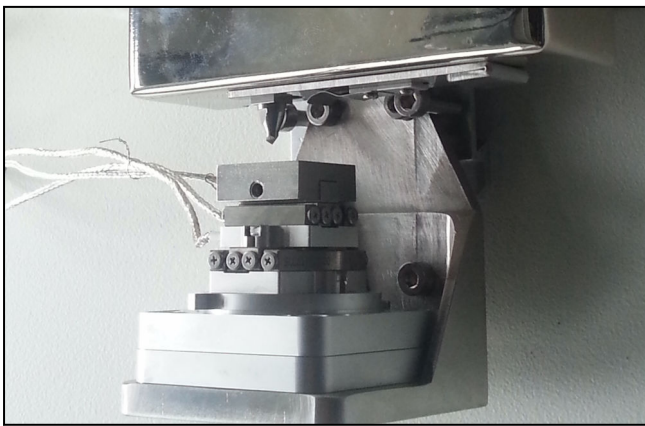
Rotationstisch ermöglicht Rotation um die Indenterachse in x-y-Richtung
