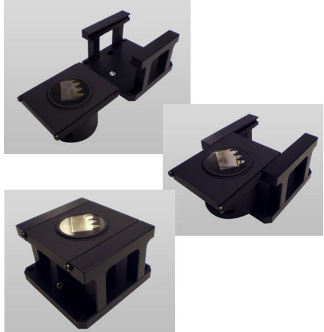
Bild 2: Probenaufnahme: separat, eingeführt, geschlossen
