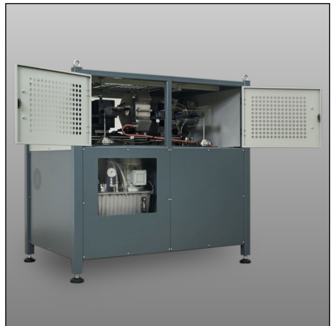
Rückwand geöffnet - Gewichteeinstellung
