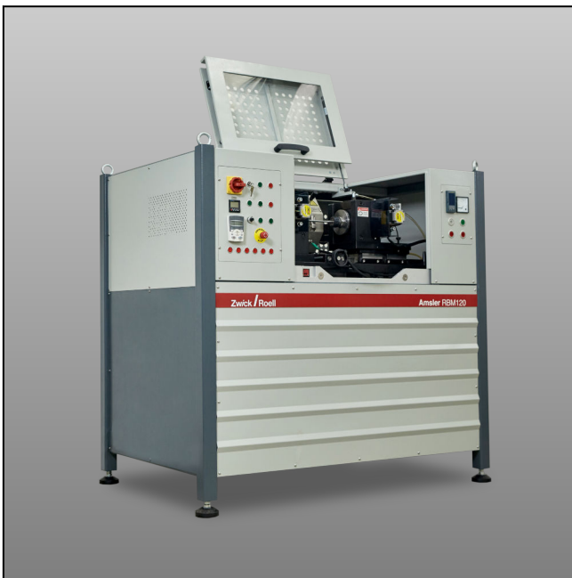
Prüfraum mit geöffnetem Deckel - Probeneinspannung
