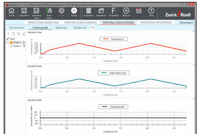
Schritt 1: Temperaturkontrolle, Stabilisierung Schritt 2: Ermittlung der thermischen Dehnung
