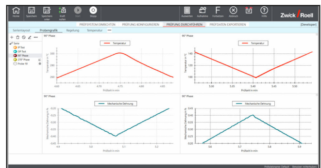
Oberer und unterer Umkehrpunkt der Temperatur (rot), oberer und unterer Umkehrpunkt der mechanischen Dehnung (blau)
