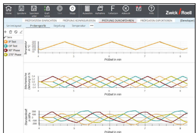
Zeitliche Verläufe von Temperatur, mechanischer Dehnung und Standardkraft (IP, OP, CD, CCD)
