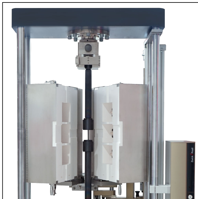
Keramik Laststrang in Zeitstandprüfmaschine Kappa SS
