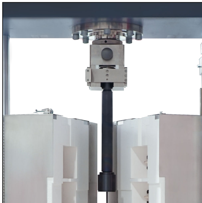
Hochtemperatur-Zuggestängeaufnahme für Zeitstandprüfmaschinen Typ Kappa SS / DS / SS-CF
