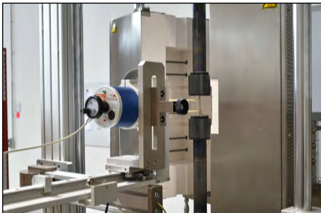
Kontaktierendes Hochtemperatur-Extensometer bis 1.500°C
