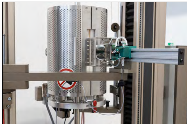
Kontaktierendes Hochtemperatur-Extensometer bis 1.600°C
