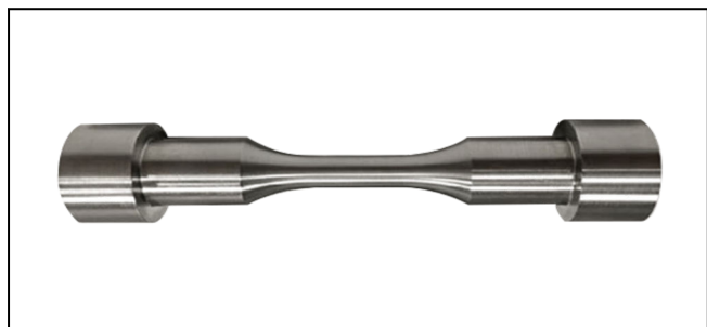
Rundprobe mit Schulterkopf für Zeitstand-Ermüdungsversuch
