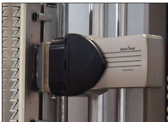
videoXtens 1-32 HP/TZ mit optischem Tunnel an Hochtemperatur-Ofen
