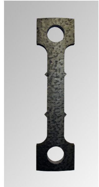
Rohrsegmentprobe mit Bündchen in der parallelen Länge
