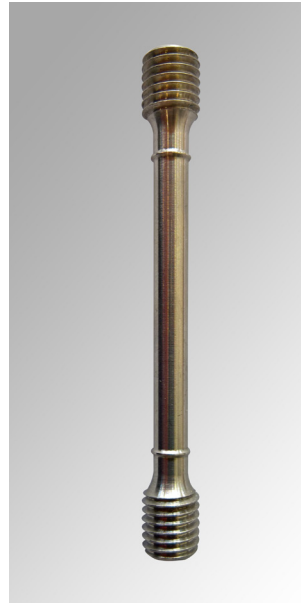
Rundprobe mit Bündchen in der parallelen Länge
