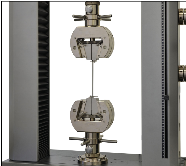
Wedge grips type 8404, Fmax 50 kN
